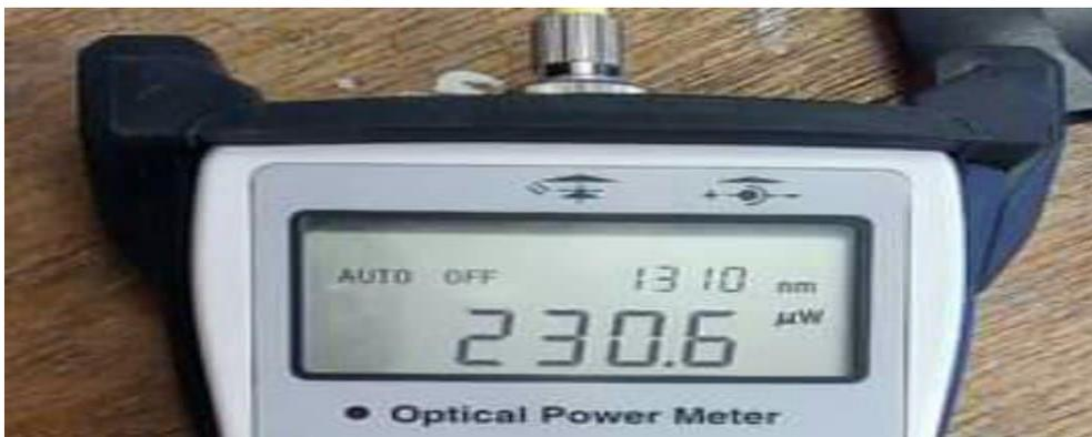
**Figure III.15 :** puissance reçue sur le wattmètre optique.
