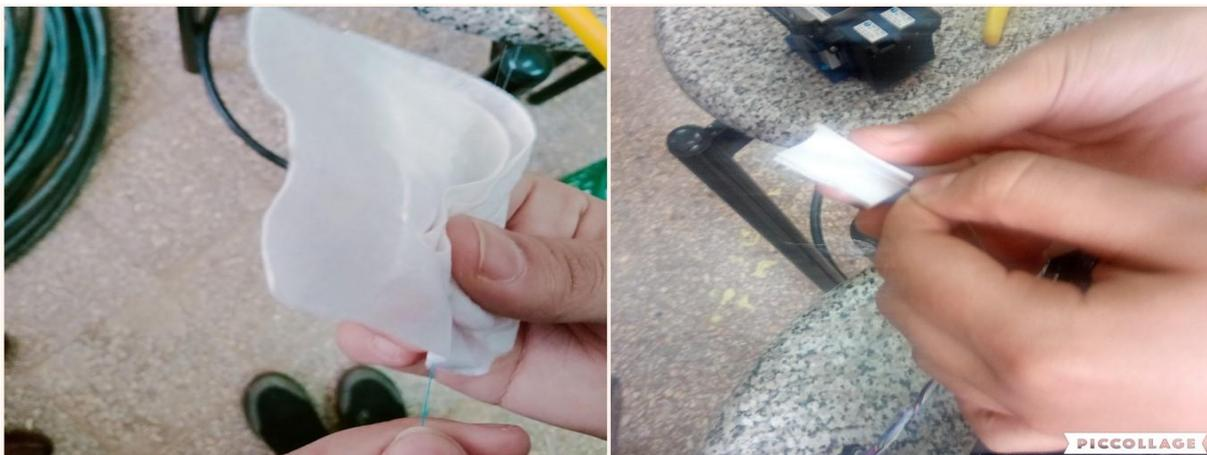
**Figure III.57:** Le nettoyage de la fibre optique.
