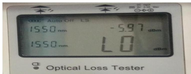
**Figure III.37:** puissance d'entrée générée par la source laser
