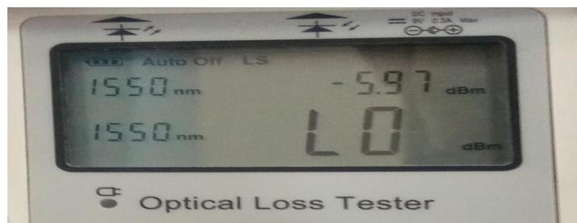
**Figure III.35:** puissance d'entrée générée par la source laser
