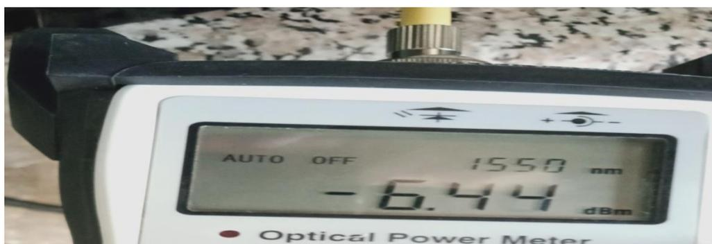
**Figure III.71:** Puissance reçue sur le wattmètre optique
