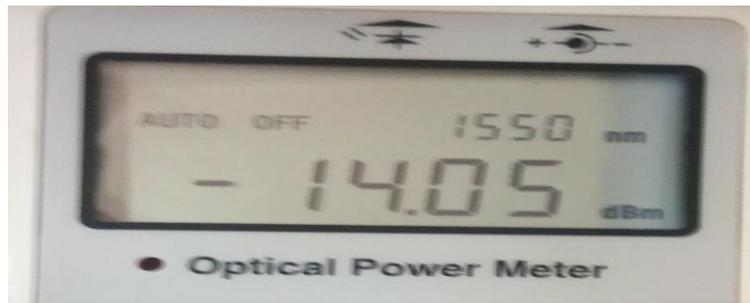
**Figure III. 38 :** Puissance reçue sur le wattmètre optique
