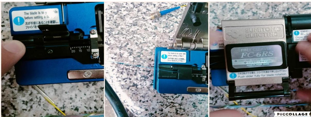
**Figure III.65:** Les étapes de clivage de la fibre optique.
