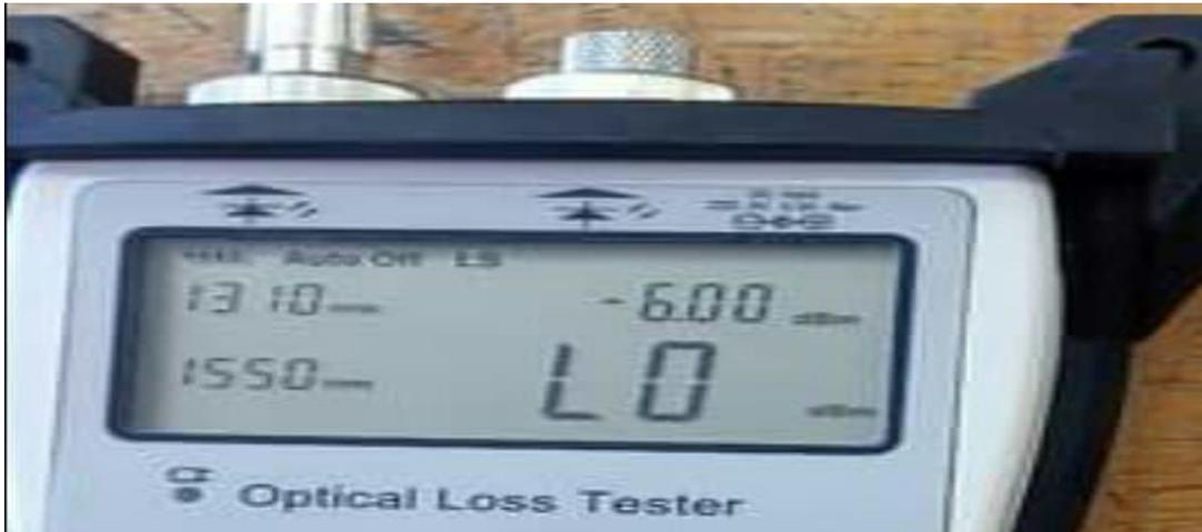
**Figure III.14:** puissance d'entrée générée par la source laser.
