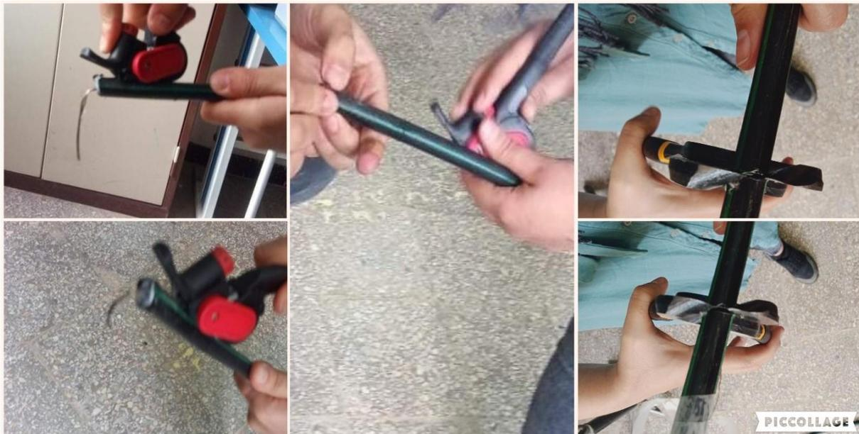
**Figure III.52:** dégainer la gaine extérieure du câble.
