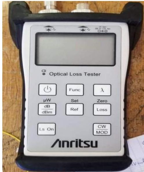
**Figure III.2:** Source laser/testeur de pertes, model 5LT35 d'ANRITSU.
