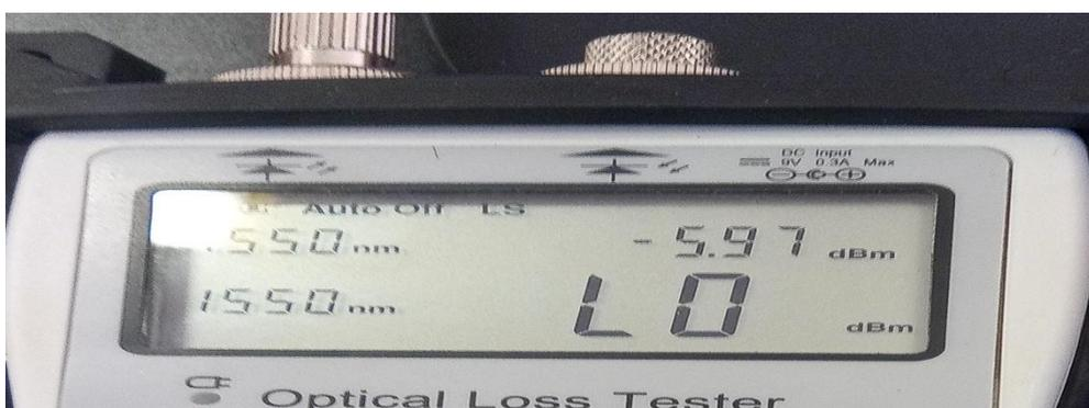
**Figure III.8 :** puissance d'entrée générée par la source laser.
