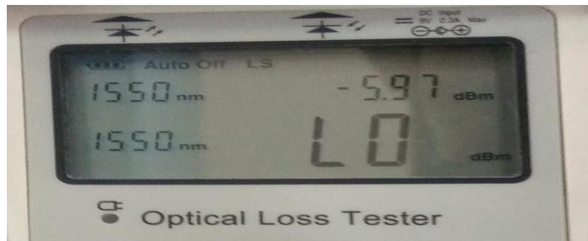
**Figure III.33 :** Puissance d'entrée générée par la source laser
