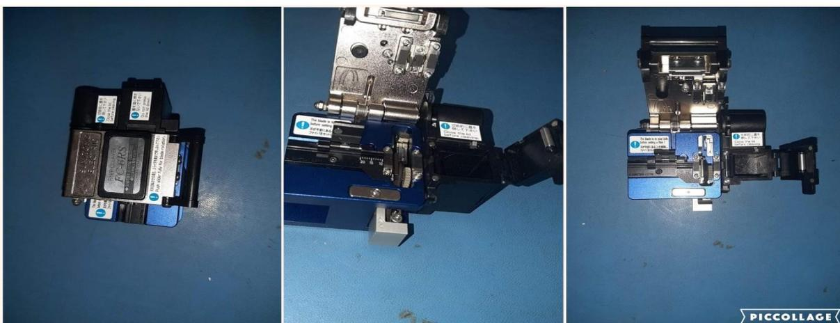
**Figure III.58:** Cliveuse FC-6RS-C de Sumitomo.
