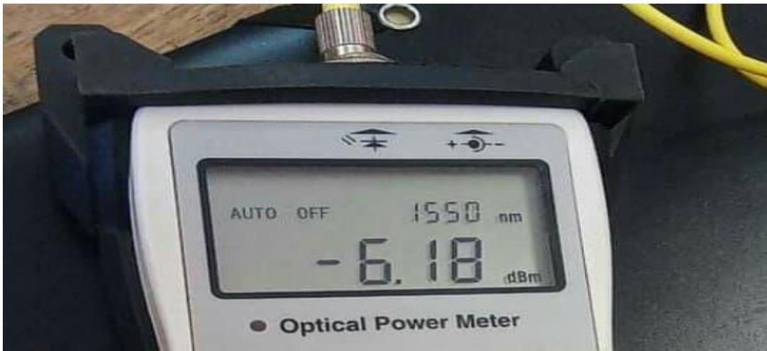
**Figure III.6:** puissance reçue sur le wattmètre optique
