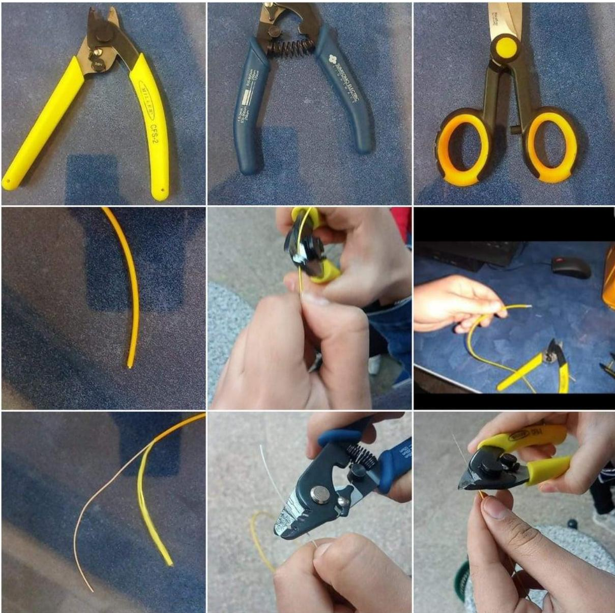
**Figure III.18:** les étapes de dénudage d'une fibre.
