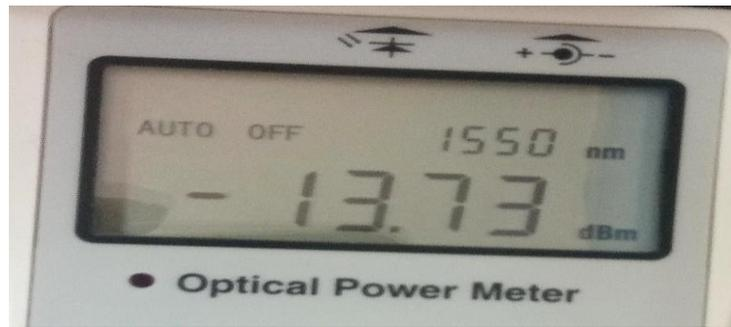
**Figure III.40:** Puissance reçue sur le wattmètre optique
