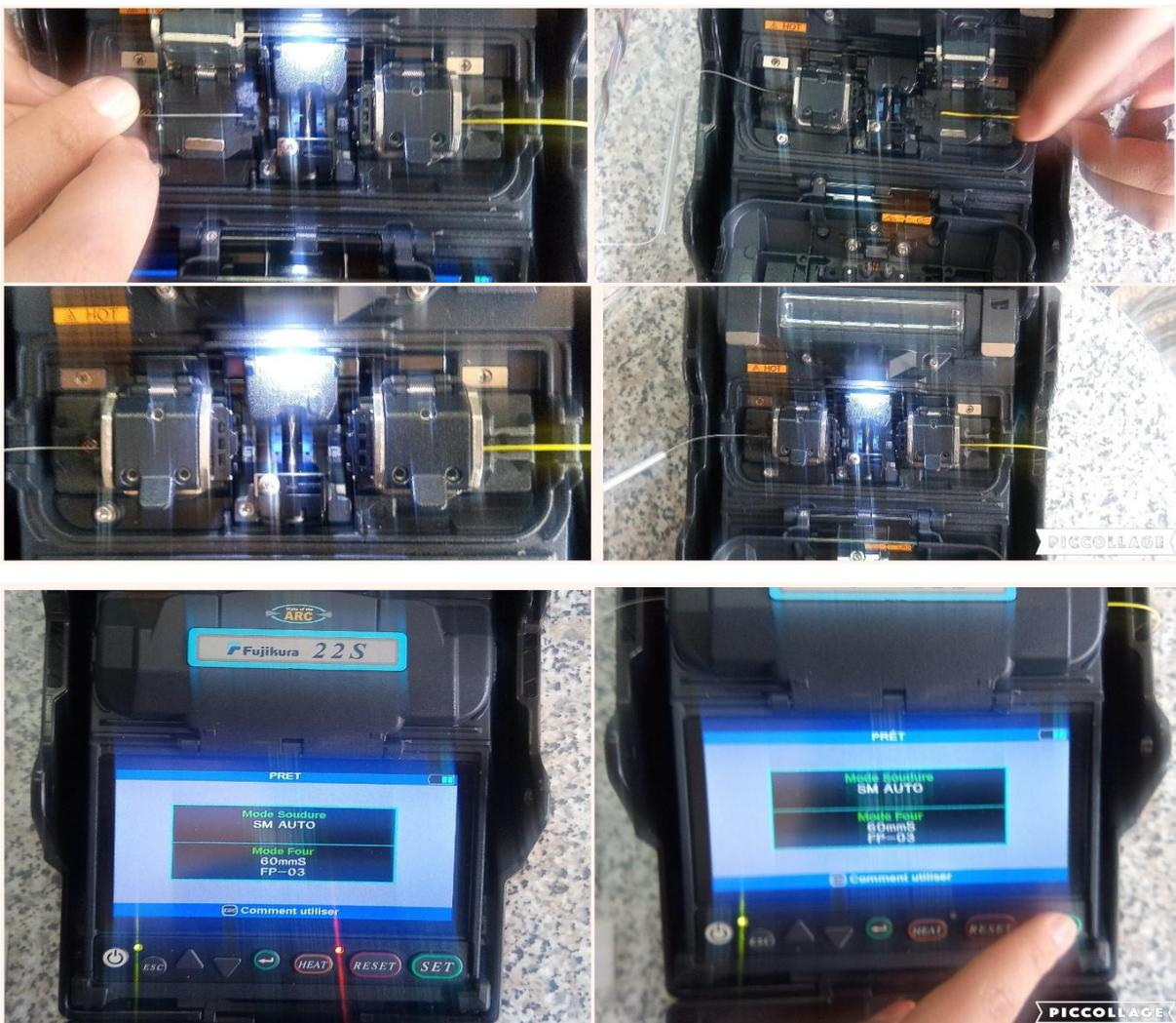
**Figure III.23:** Les étapes de soudure de la fibre optique.
