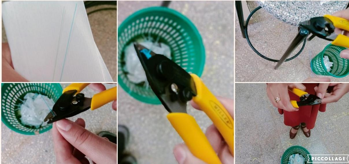
**Figure III.56:** les étapes de dénudage d'une fibre.
