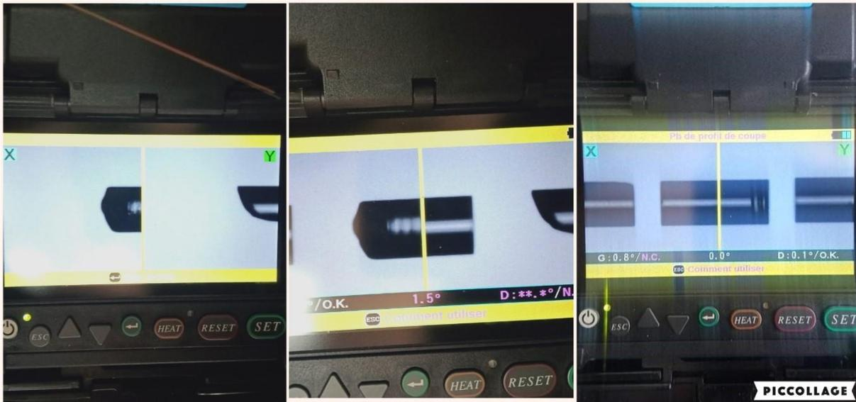
**Figure III.24:** Mauvais soudure.
