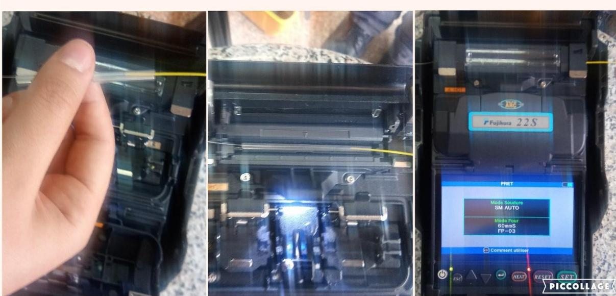
**Figure III.26:** Les étapes de la fusion de la fibre optique.
