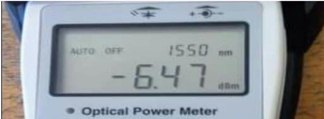
**Figure III.9 :** puissance reçue sur le wattmètre optique.
