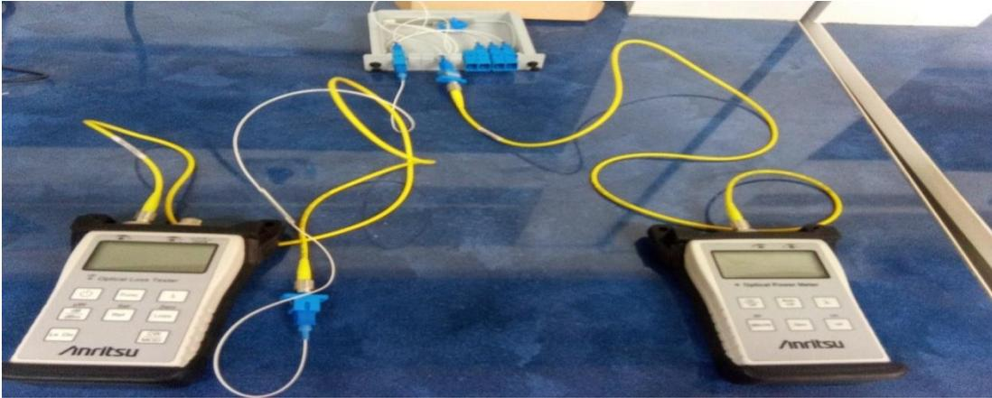
**Figure III.32:** Mesure de la puissance reçue et la perte optique
