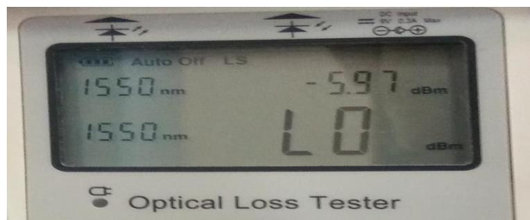
**Figure III.39 :** puissance d'entrée générée par la source laser
