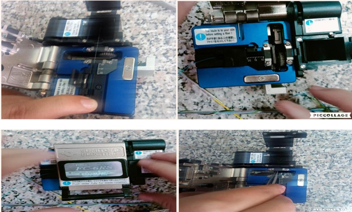
**Figure III.59:** Les étapes de clivage de la fibre optique.
