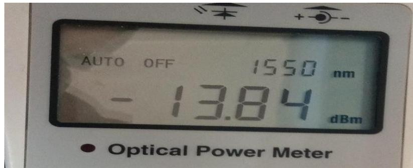
**Figure III. 36 :** Puissance reçue sur le wattmètre optique
