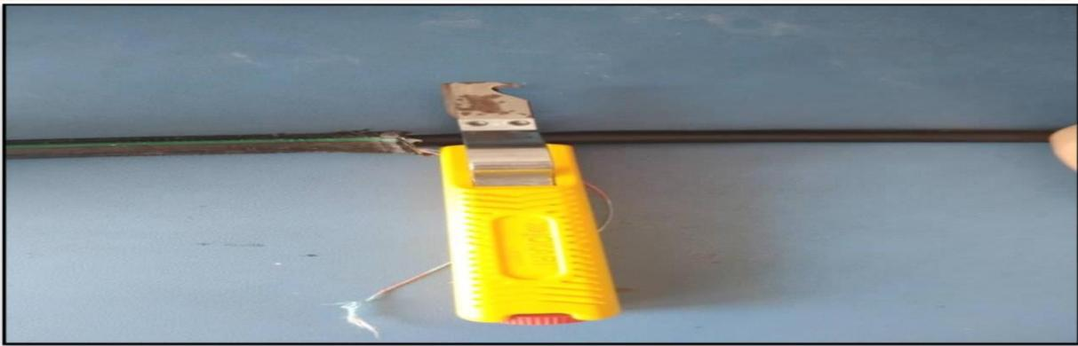
**Figure III.53:** Dé-tuber les tubes ou le micro gaine.
