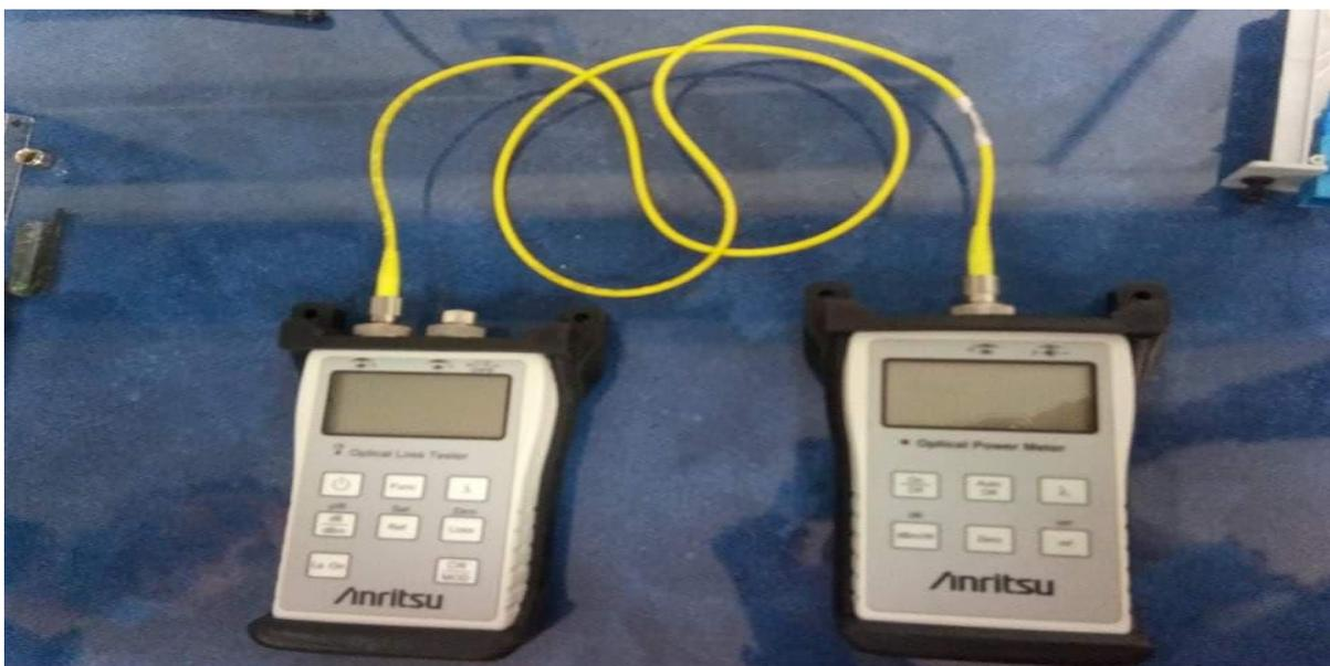
**Figure III.4 :** Méthode expérimentale de mesure de pertes d'insertion optiques.
