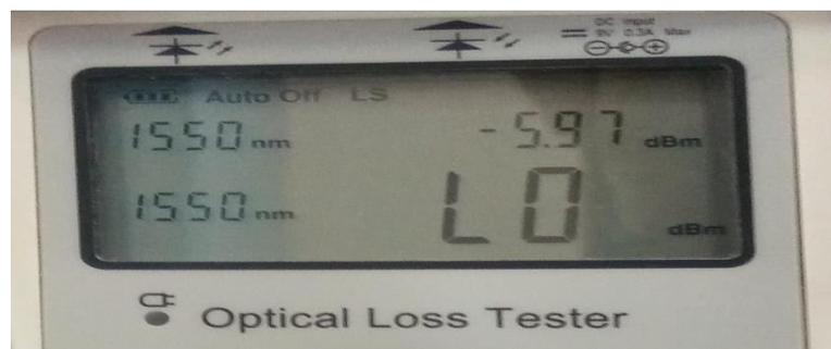
**Figure III.46 :** Puissance d'entrée générée par la source laser
