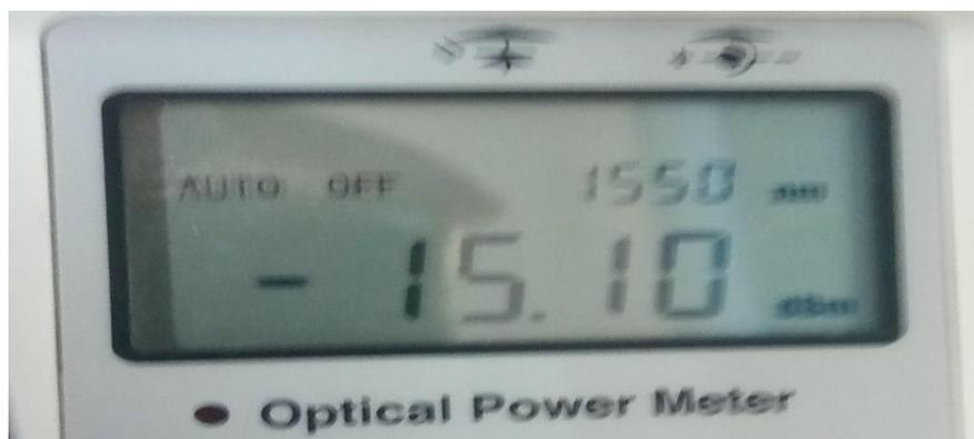
**Figure III. 34 :** Puissance reçue sur le wattmètre optique
