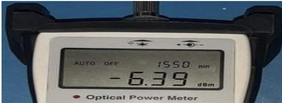
**Figure III.30:** puissance reçue sur le wattmètre optique.
