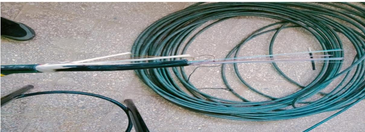
**Figure III.50:** Câble semi-rigide à 72 brins de fibres optiques.
