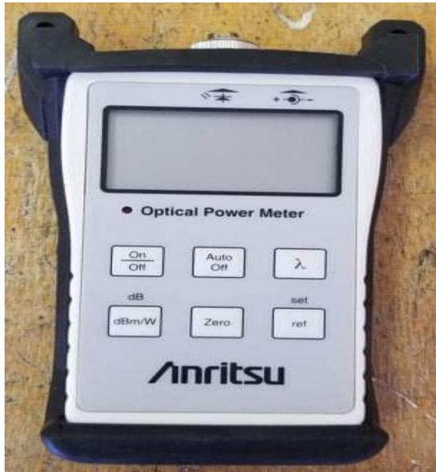
**Figure III.3:** Commandes de fonctionnement du wattmètre optique de la série CMA5.
