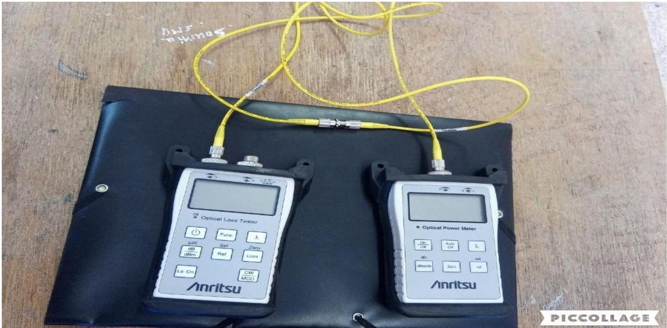
**Figure III.7:** Mesure de perte optique de deux fibres optiques et un adaptateur.
