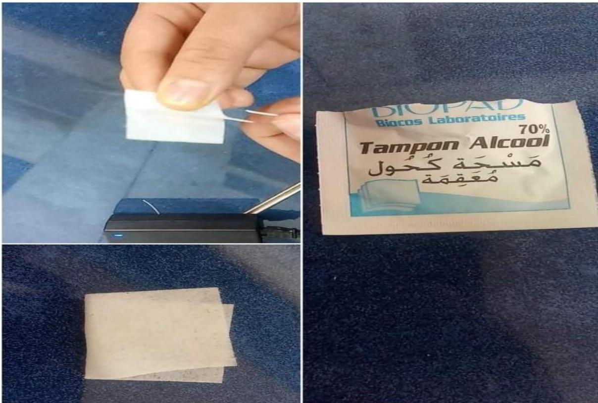
**Figure III.19:** Le nettoyage de la fibre optique.
