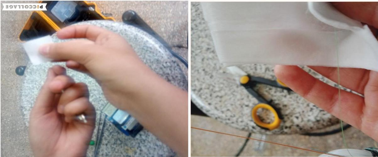
**Figure III.64:** Le nettoyage de la fibre optique.
