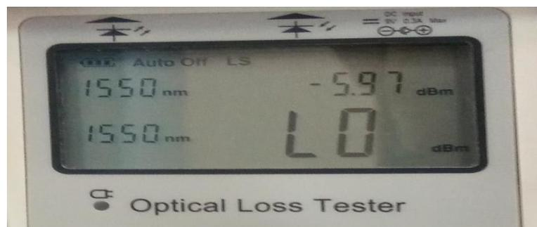
**Figure III.43 :** puissance d'entrée générée par la source laser
