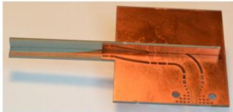
**Figure II. 20** Photographie de l'antenne pliée PTSA fabriquée.
