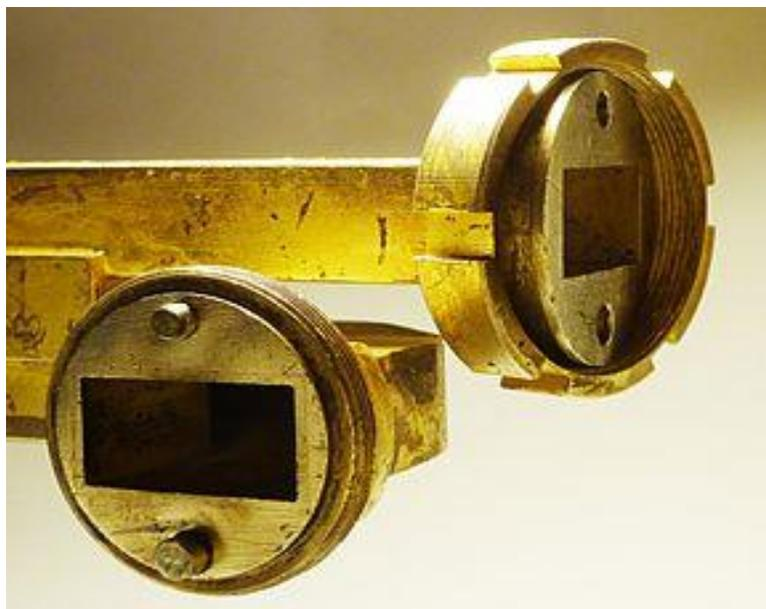
**Figure II. 1** Exemple d'un guide d'ondes hyperfréquences.
