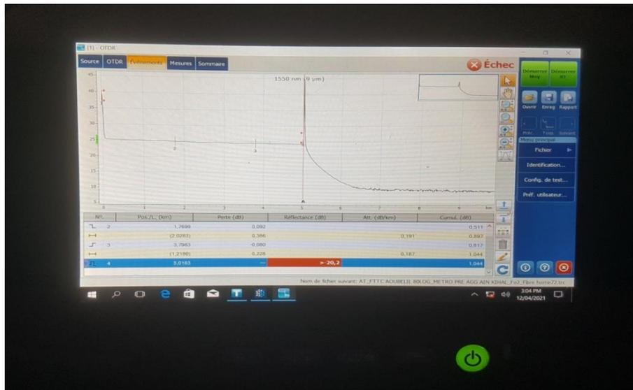
**Figure III.7:** Résultats du 1<sup>er</sup> test sur l'interface OTDR.
