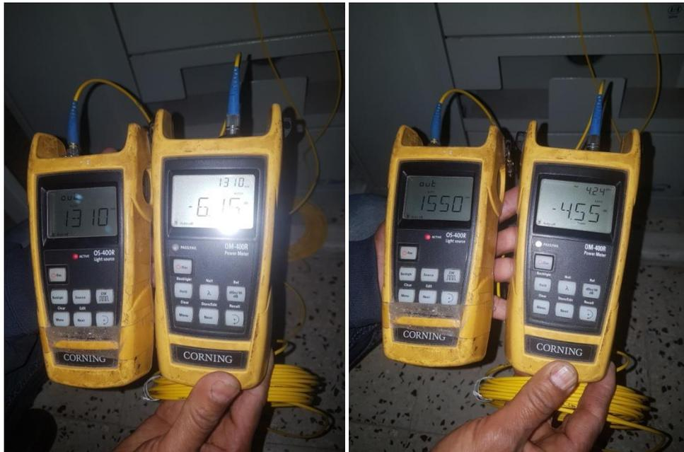
**Figure III.10:** Transmission de deux (02) impulsions par puissance-mètre
