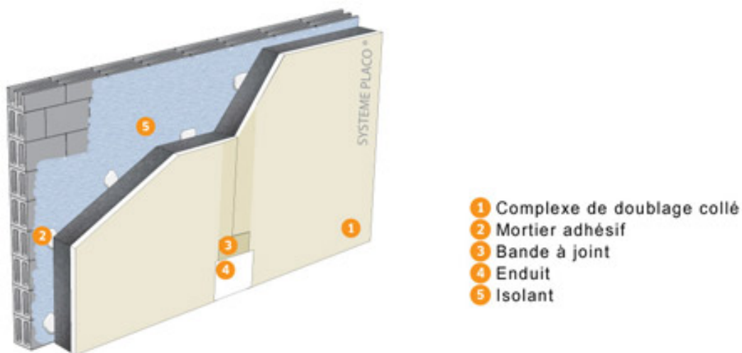
Figure 4. 2: Isolation thermique d'un mur par l'intérieur
