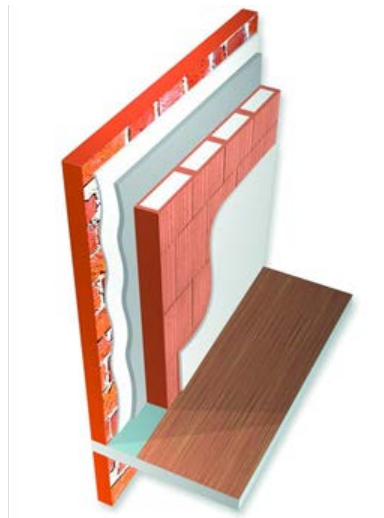
Figure 4. 7: Brique mono-alvéoles remplies de perlite
