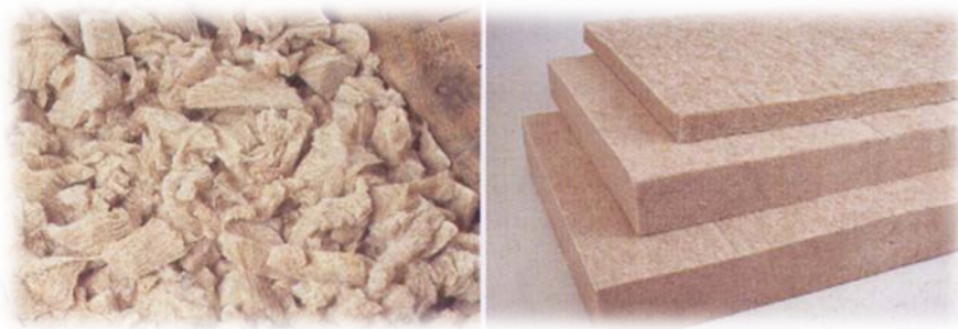
Figure 2. 14: Laine de lin en vrac, laine de lin en rouleaux et laine de lin en panneaux (doc. Textinap).
