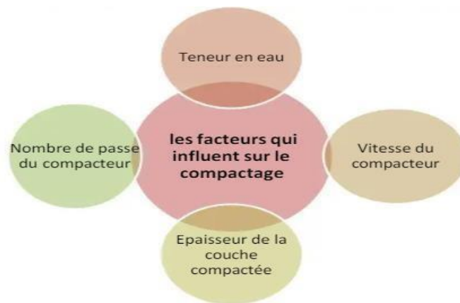
FIGURE I. 17- les facteurs qui influent sur le compactage -
