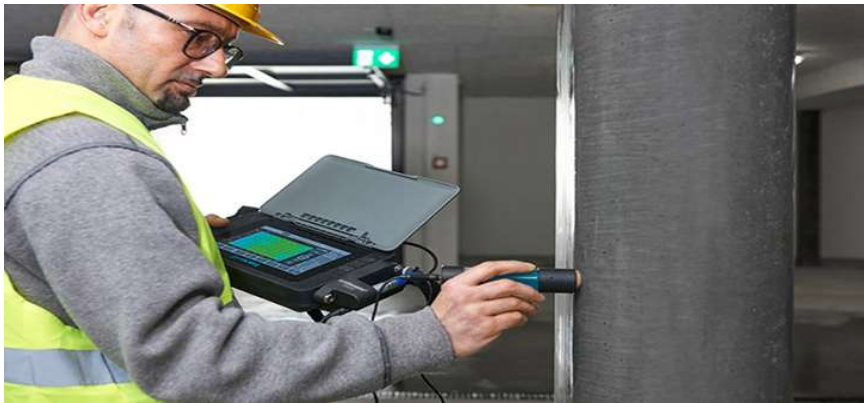
Figure 4.4 : Instruments de mesure du potentiel de corrosion. (proceq.com)
