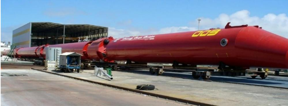
**Figure 34 : Pelamis avant sa mise à l'eau (Ocean Power Delivery Limited)**
