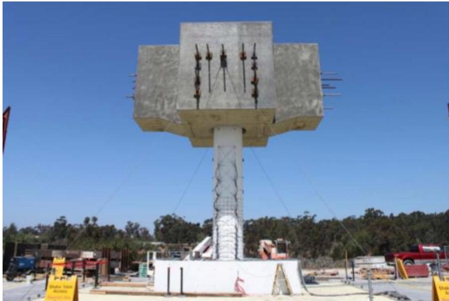
Figure 46 : Test spécimen footing, column, superstructure
