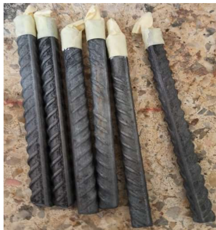
Photo2.1 : Les échantillons en acier retirés de la solution neutre.
