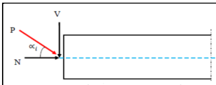
(FIGURE 6-III) composante de la précontrainte à l'about
