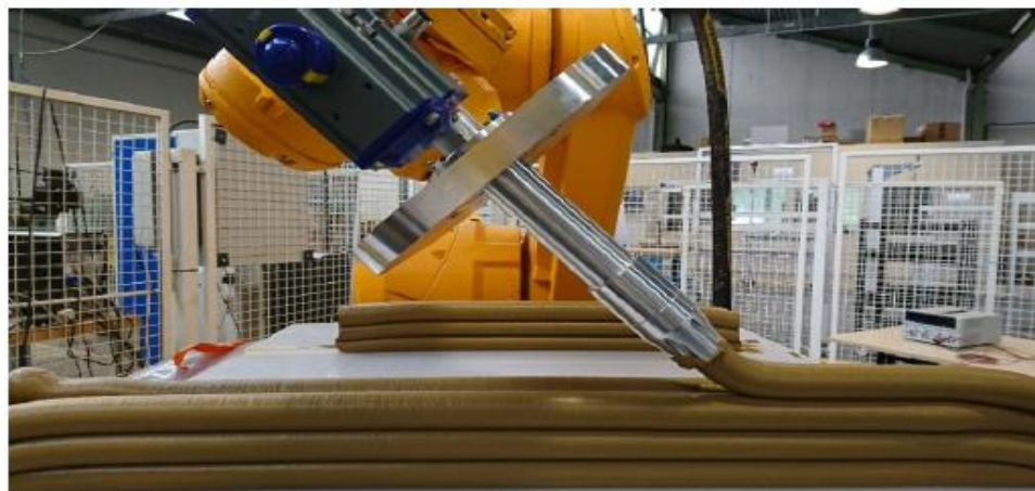
Figure 1.13 : Dépôt de couches de mortier lors de l'impression par extrusion/dépôt [12]
