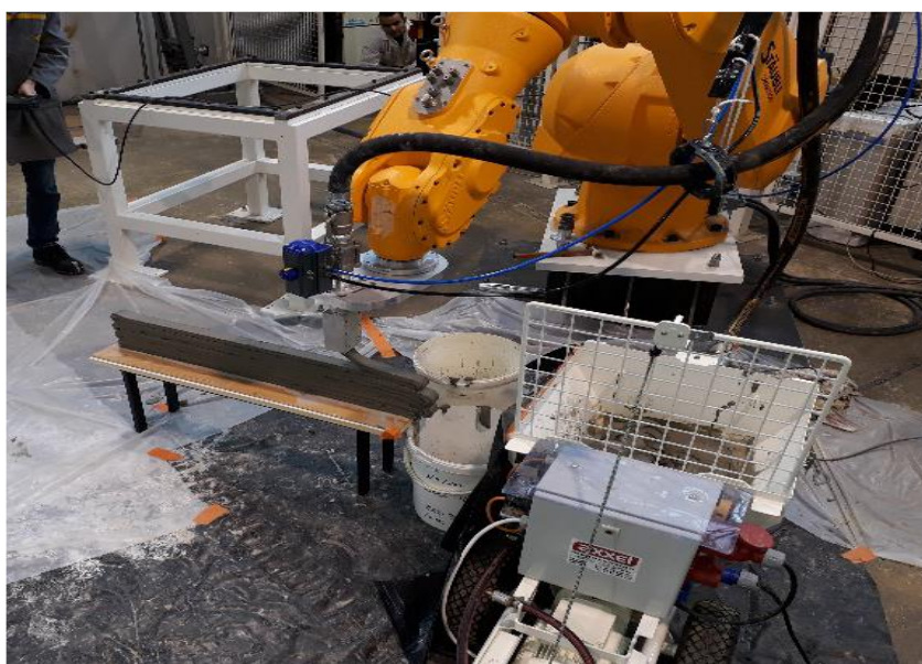
Figure 2.4 : Impression 3D de mortier par extrusion/dépôt réalisée en laboratoire. Bras articulé et pompe à mortier
