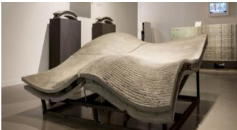
Figure 3.12 : Réalisation d'une structure imprimée par l'université de Loughborough[18]
