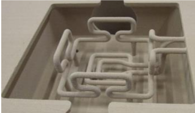
Figure 2.12: Noyaux de moules de fonderie produits par fabrication additive sable – projet I Techmould – partenaires : ARRK Shapers', Safe Metal, FPSA, CTIPC, CTIF, ID PRO (Lycée Hector Guimard) et l'Enise. [22]
