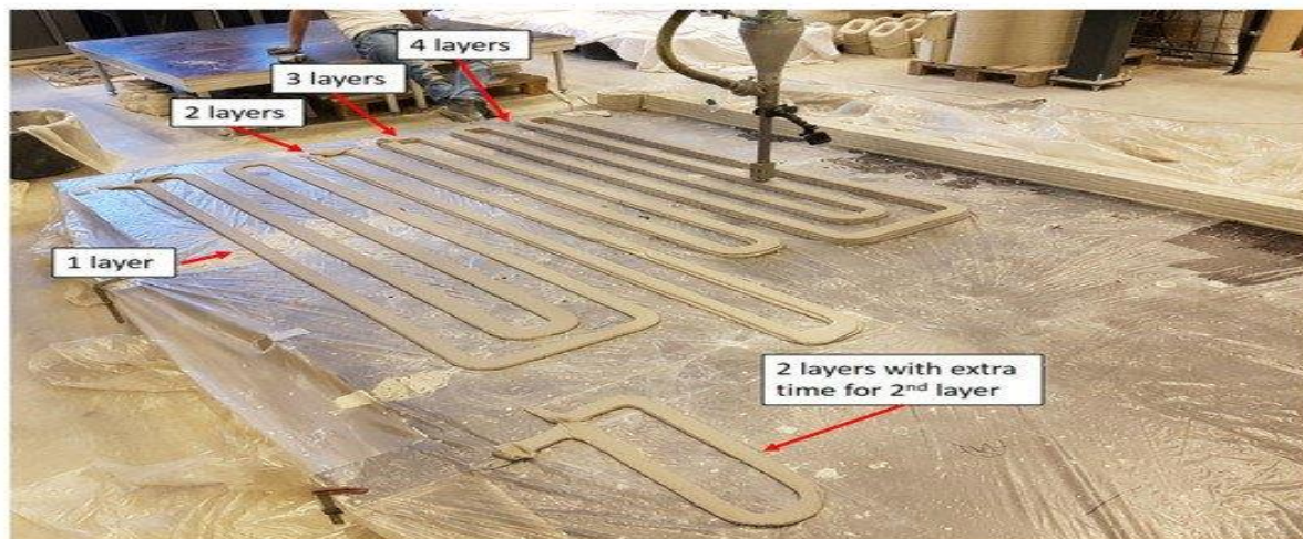
Figure 3.3 : Impression avec l'un des composites cimentaires à durcissement sous contrainte renforcés de fibre PVA [9]
