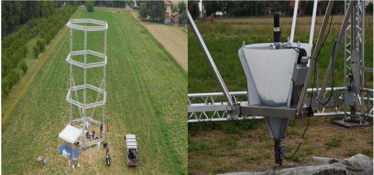
Figure 2.13 : Imprimante 3D géante (Bigdelta) [25]
