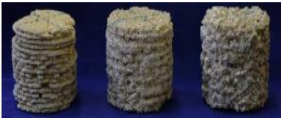
Figure 2.10 : éprouvettes imprimées par liaison sélective.
