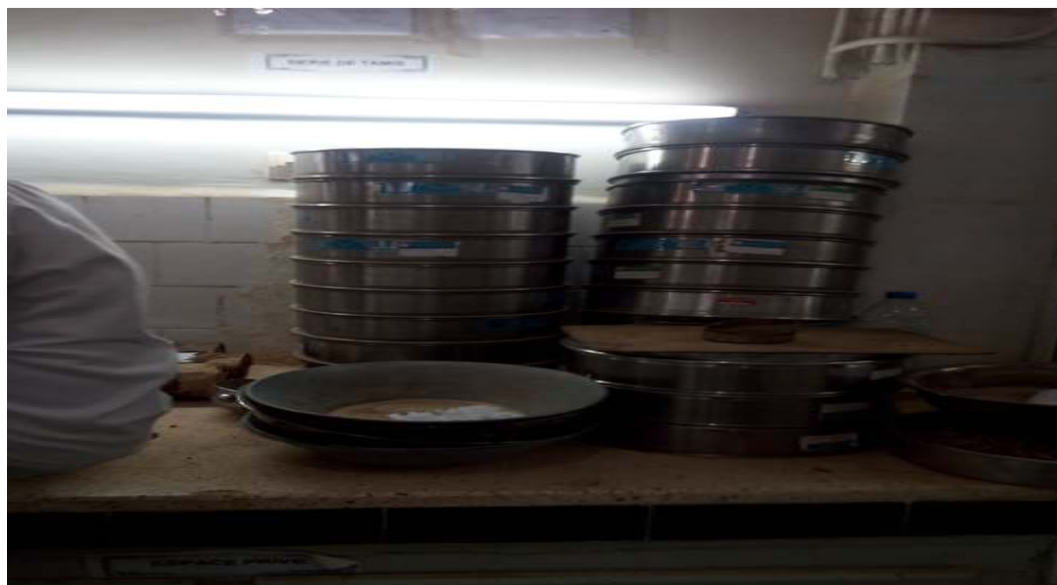
Figure (3.19) : Appareillage d'essai granulométrique par voie humide (tamiseuse)
