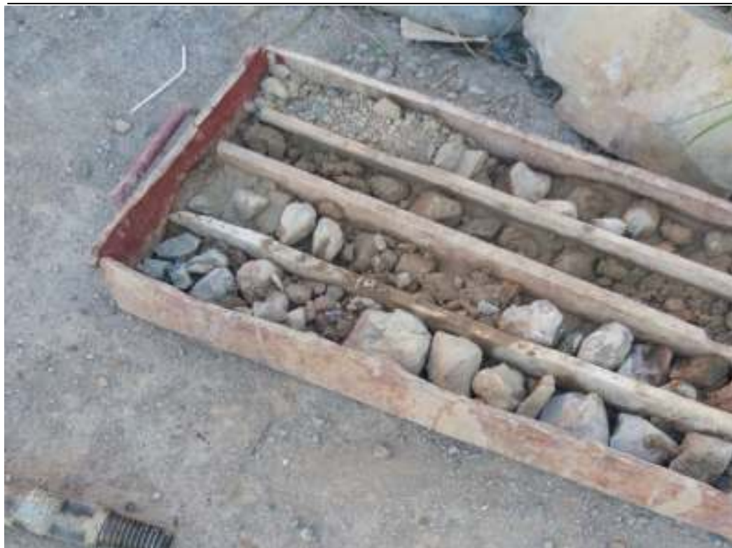
Figure (3.18): Caisse de carottes prélevées après un sondage
