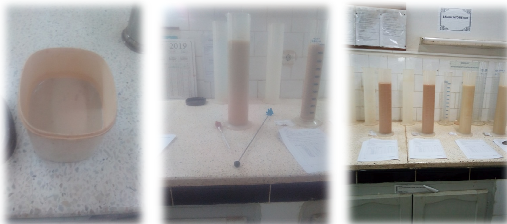
Figure (3.20): Appareillage d'essai sédimentométrie
