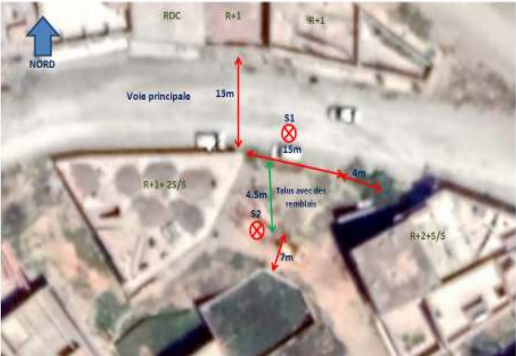
Figure (3.16): localisation du site et l'implantation des sondages
