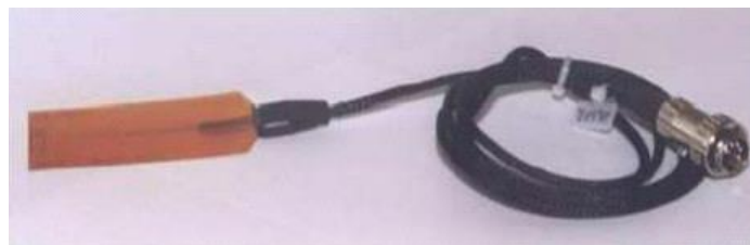
Figure 2.16 : Vue d'une sonde de type fil chaud
