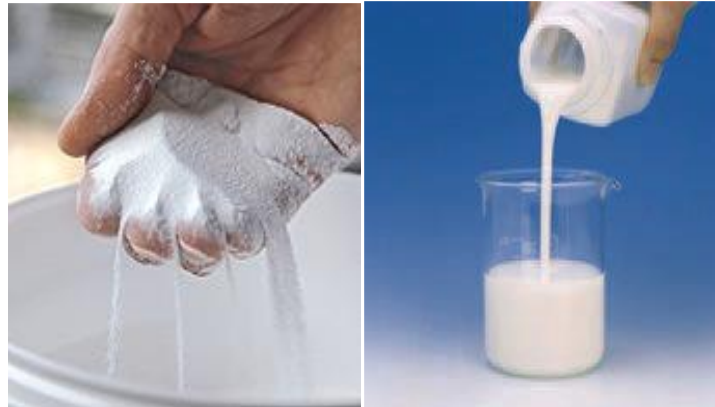
Figure 1.3 : Exemple des MCP microencapsulés : à l'état poudre et à l'état liquide (BASF).
