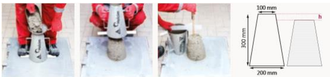
Figure 2.2 : Mesure de l'affaissement (Slump) selon la norme SN EN 12350-2
