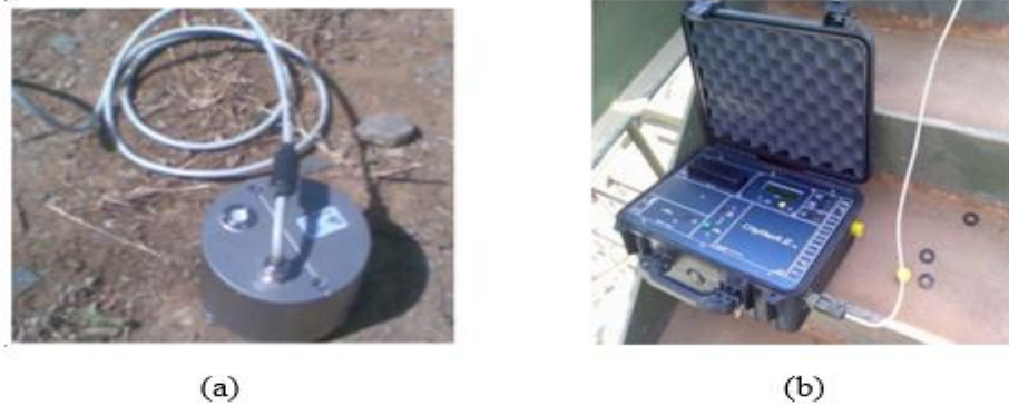
Figure 1-2. Dispositif d'essai de vibration ambiante a) Exemple d'un sismomètre d'enregistrement des vibrations ambiantes. b) Station d'acquisition
