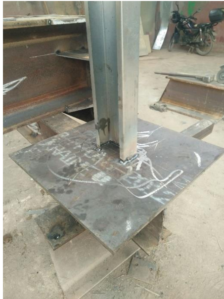
Figure 3-3. Pied du Poteau spécimen
