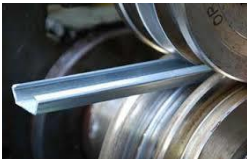
Figure 2-4. Le profilage de feuillards en acier (Galets de profilage)
