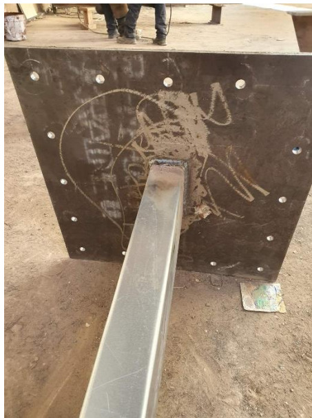
Figure 3-4. Pied du spécimen pour fixation sur la table
