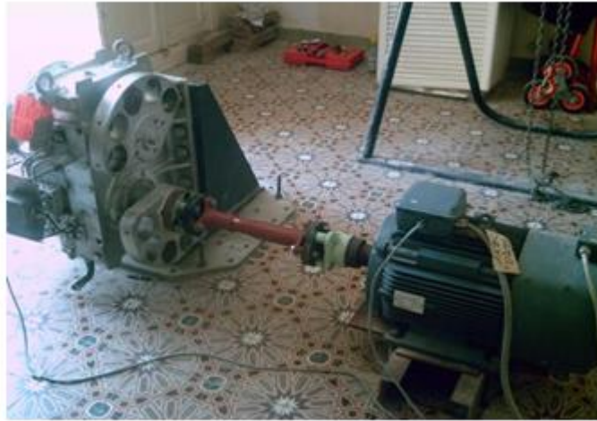
Figure 1-3. Dispositif d'essai de vibrations forcées.
