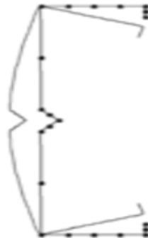
Figure 2-17. Instabilité distorsionnelle d'une section C avec raidisseur d'âme
