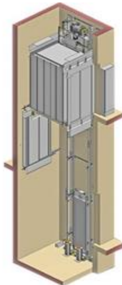
Figure 1.17 ascenseur sans salle des machines
