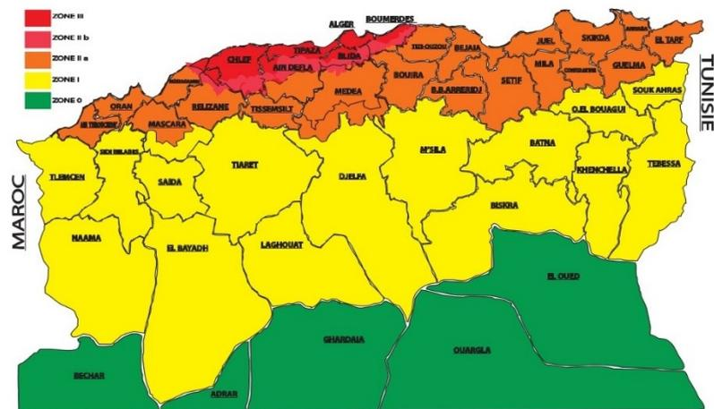
Figure 2.7: zonage sismique de l'Algérie
