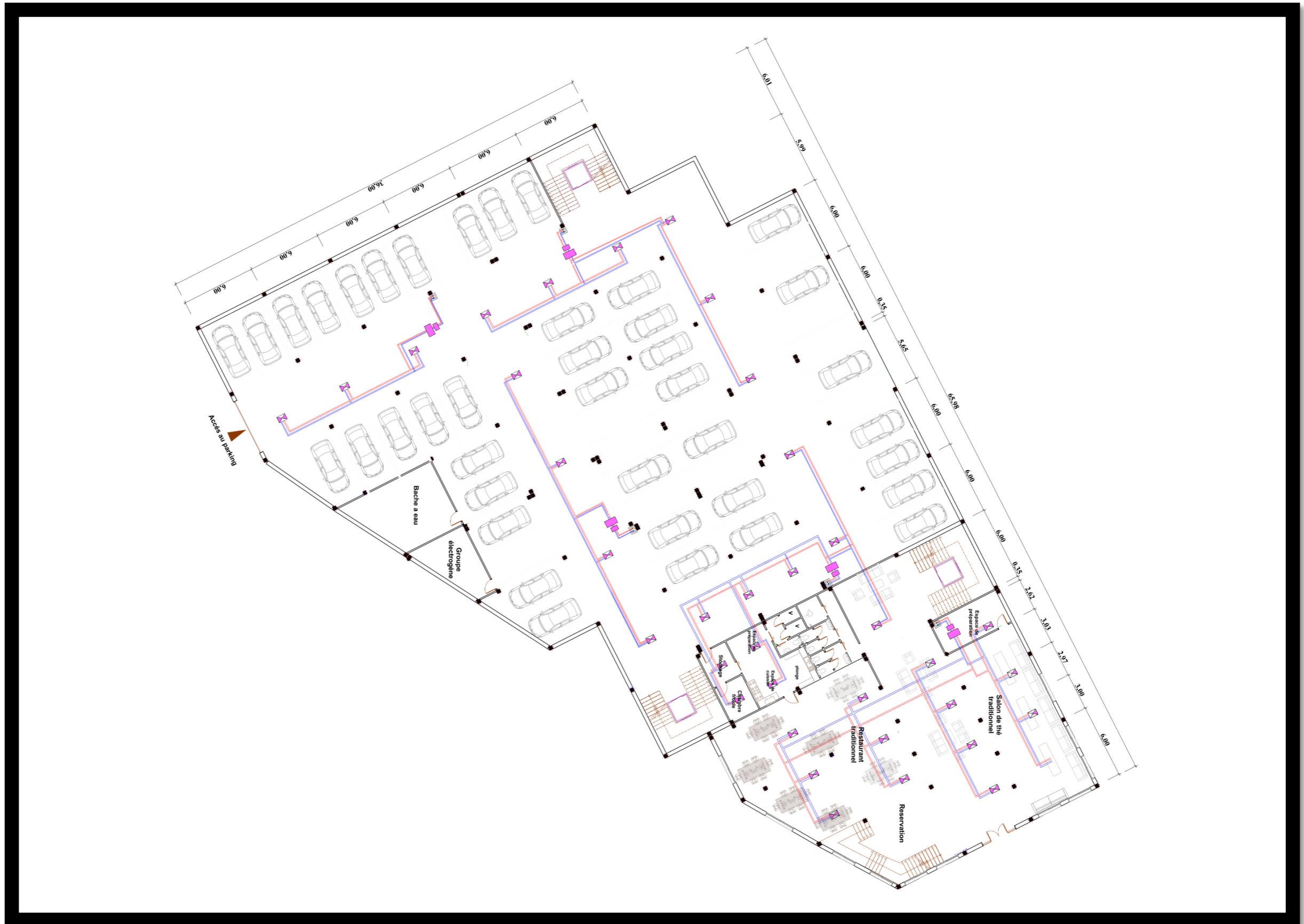
Plan climatisation sous-sol
