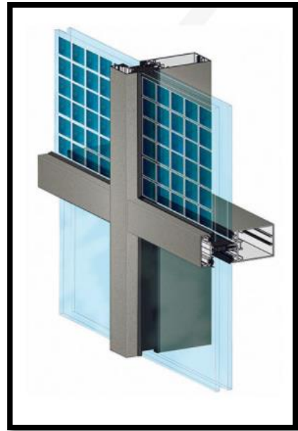
Figure 74: Détails mur rideau
