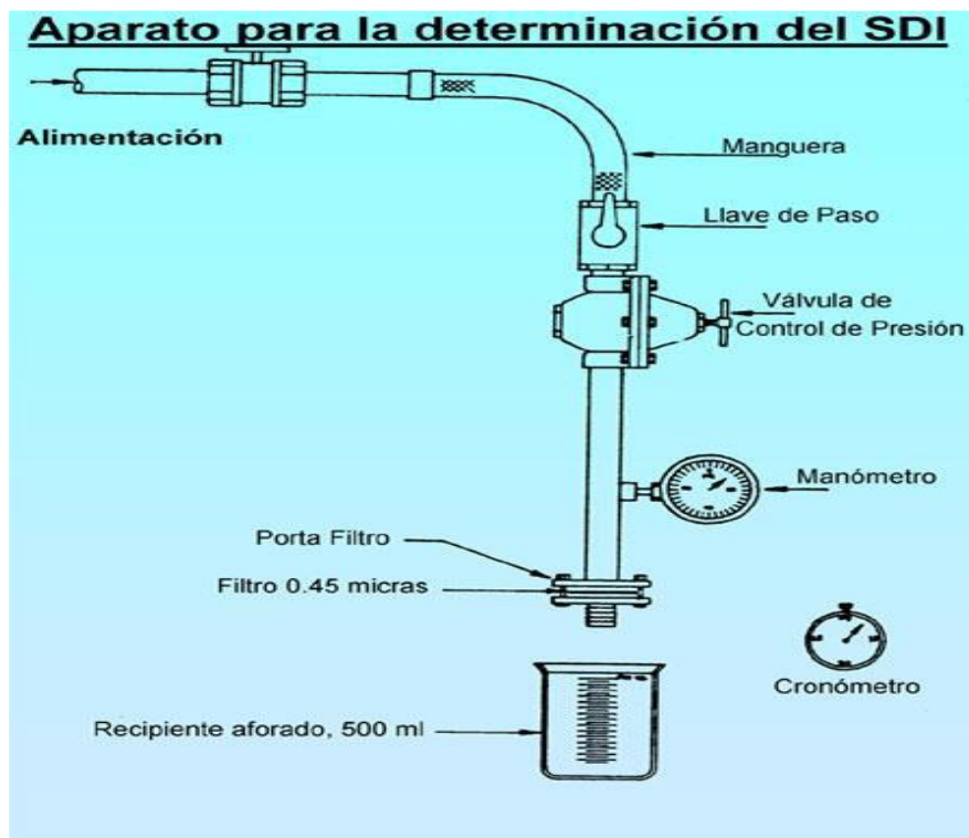
Figure 44:Appareil de détermination de SDI [48].
