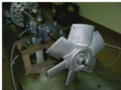
Figure 1.25 : Banc d'essai d'un rotor dynamique(les forces aérodynamiques) [29]
