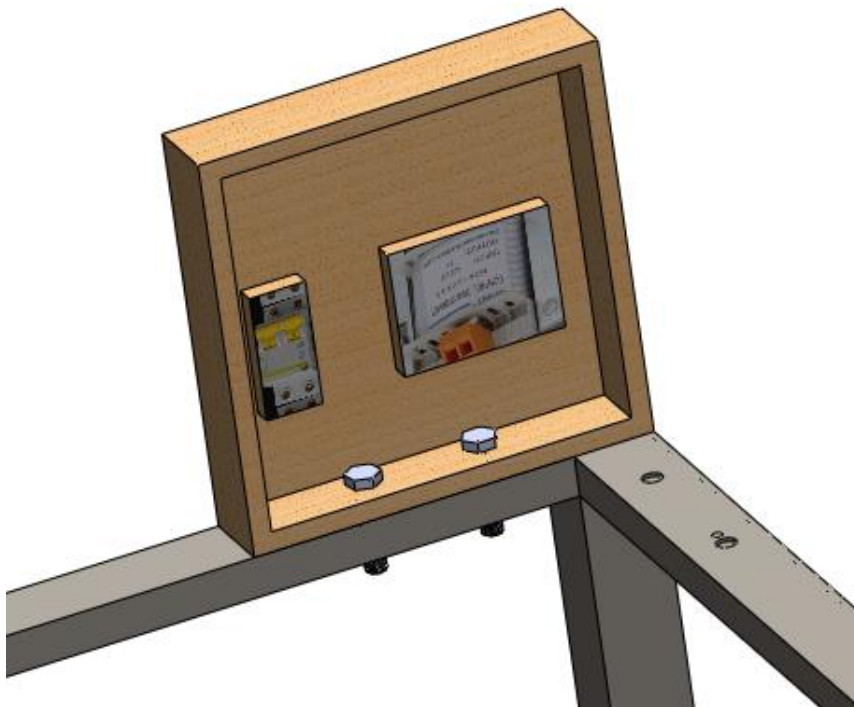
Figure 4.16 : Vue 3D de l'assemblage de la boîte de commande avec le bâti 1.
