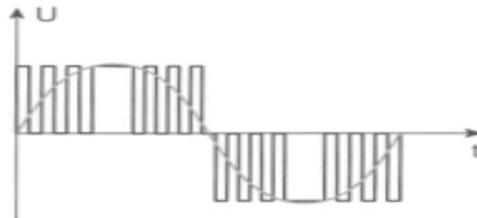
Figure 3.16 : Principe de découpage de la tension continue pour obtenir une tension sinusoïdale
