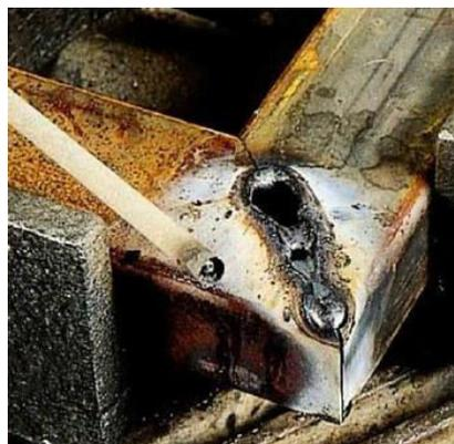
Figure II.4 : Mauvais choix de diamètre de l'électrode.
