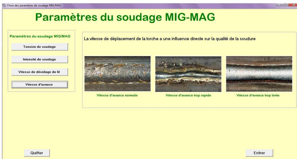
Figure. III.25 : Vitesse d'avance pour soudage MIG/MAG.
