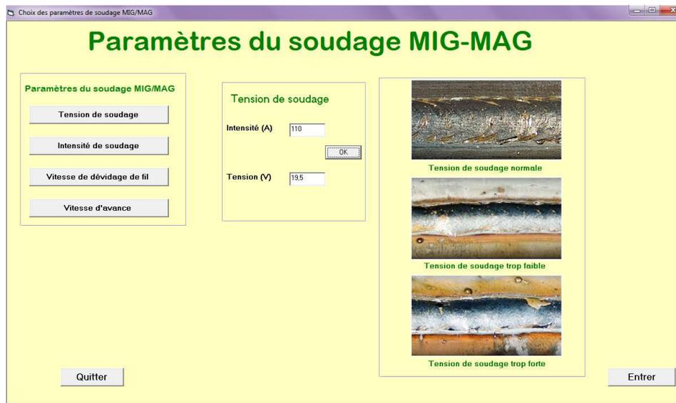
Figure. III.22 : Tension de soudage MIG/MAG.
