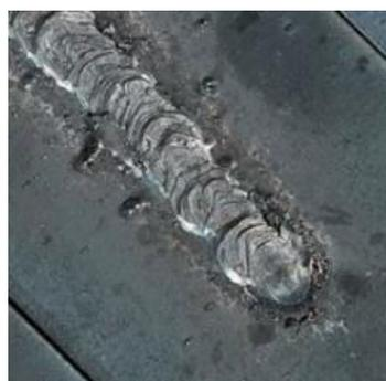
Figure II.6 : Longueur d'arc supérieure à la normale.
