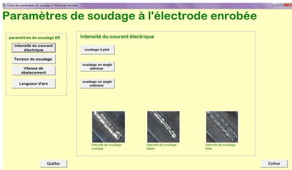
Figure III.14: Intensité de soudage SMAW.
