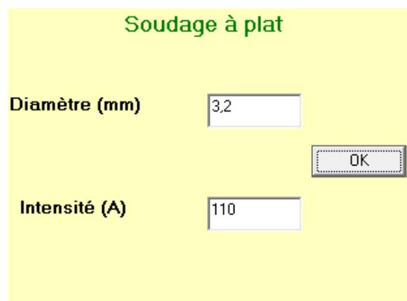
Figure III.15 : Calcul de l'intensité de soudage à plat.
