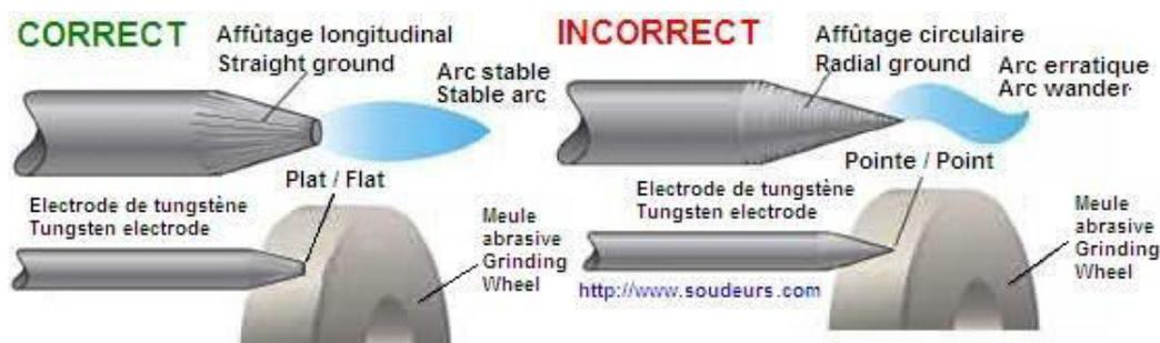
Figure II.11: Choix de l'affûtage des électrodes.
