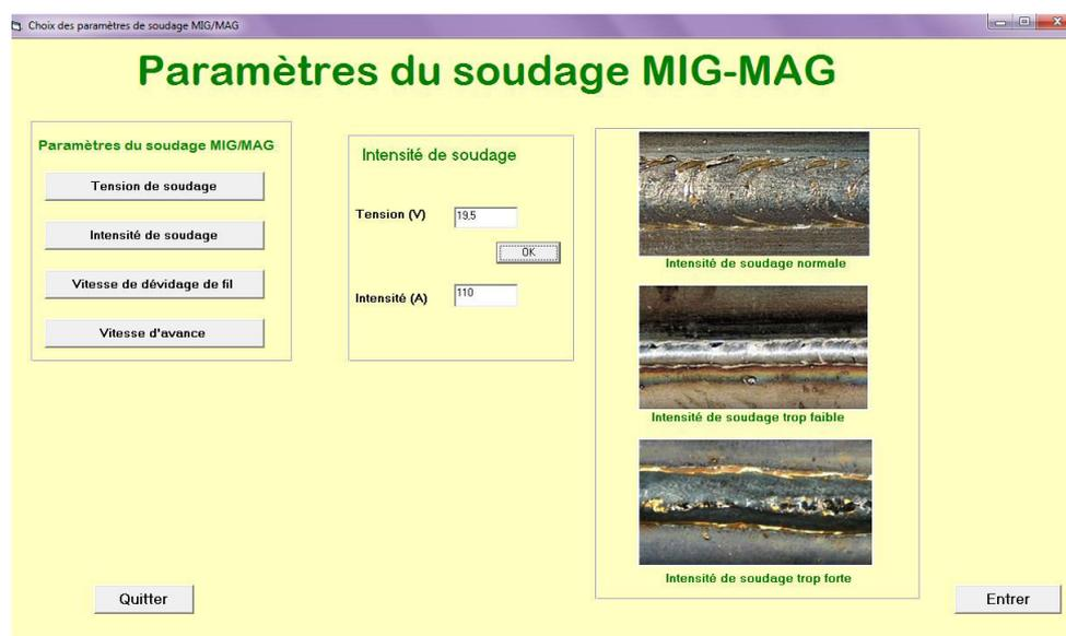
Figure. III.23 : Intensité de soudage MIG/MAG.
