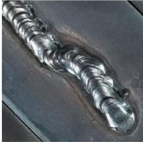
Figure II.7 : Longueur d'arc inférieure à la normale.
