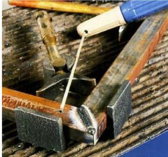
Figure. II.5 : Bon choix de diamètre de l'électrode.
