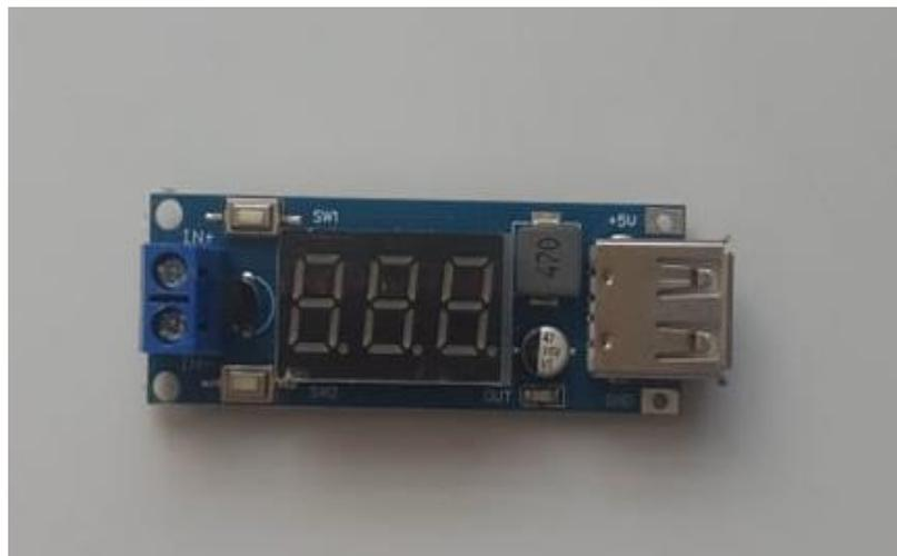
Figure 17: Régulateur de tension.
