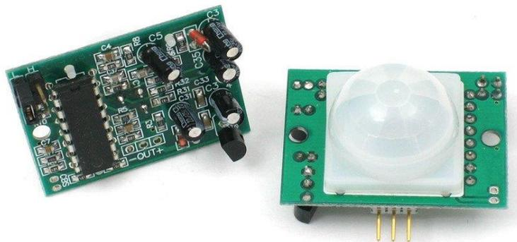
Figure 8: Capteur pir dsn-FIR800.
