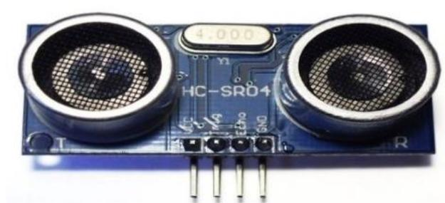
Figure 11: Capteur ultrason.
