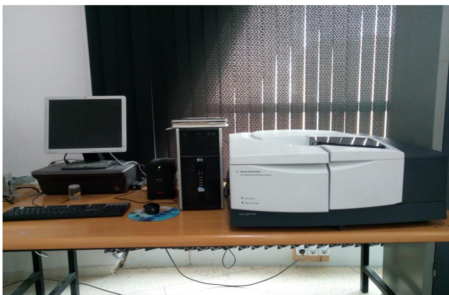
Figure II.7 : Dispositif Spectromètre Infrarouge à Transformée de Fourier (FTIR).
