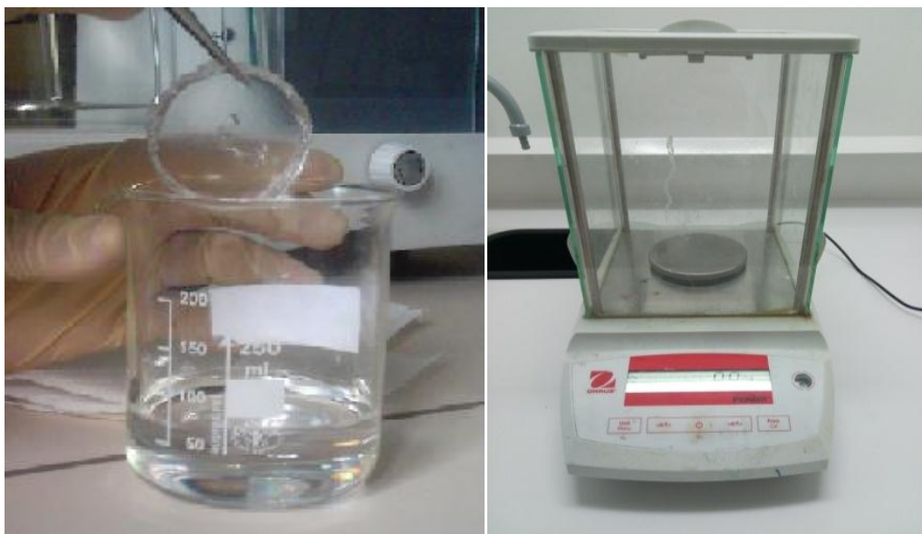
Figure III.1 : Dispositif utilisé pour l'étude du gonflement des réseaux de polymères.
