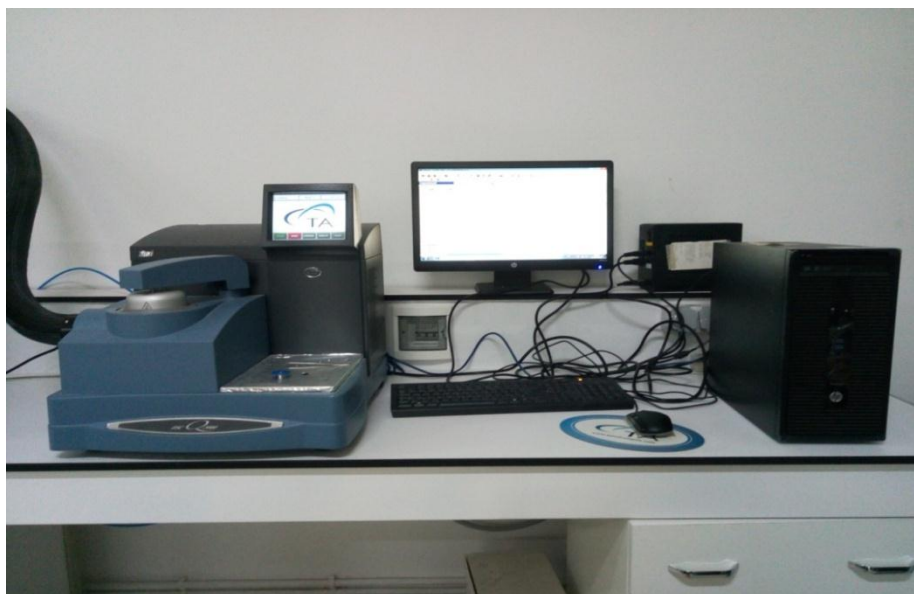
Figure IV.1 : Dispositif de mesure pour l'analyse enthalpique différentielle (DSC Q2000).
