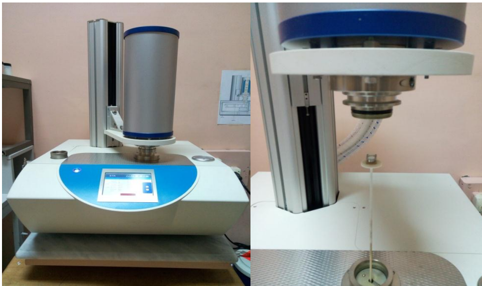
Figure IV.6 : Dispositif de mesure pour l'analyse thermogravimétrique (ATG).
