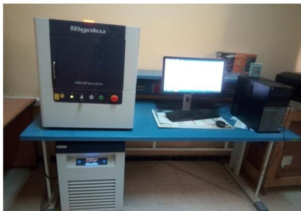
**Figure. II.2.** Appareil de la DRX (Rigaku MiniFlex 600).
