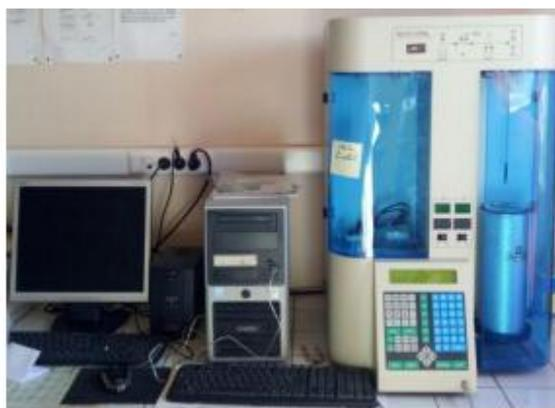
**Figure II. 4.** Appareil NOVA 1000e utilisé lors des mesures.
