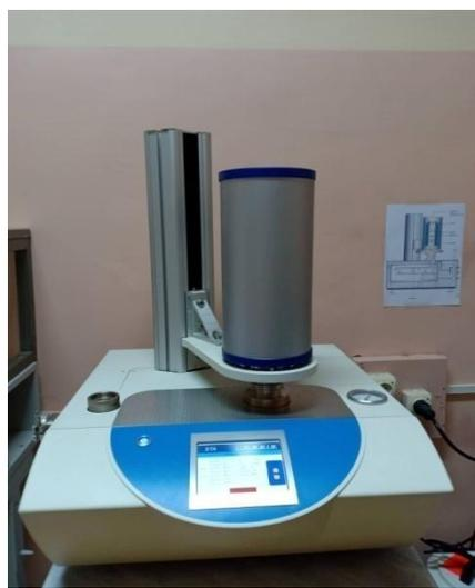
**Figure II.6.** Appareil ATG/ATG (LINSEIS.STA.PT.1600).
