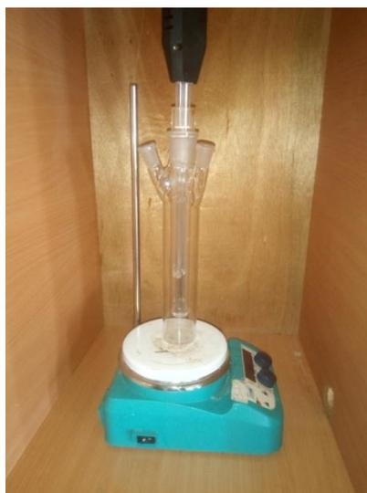
**Figure II.8.** Photoreacteur utilisé dans la Photodégradation.
