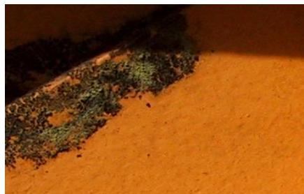
**Corrosion galvanique** : peut se définir simplement par l'effet résultant du contact de deux métaux ou alliages différents dans un environnement corrosif conducteur : on utilise aussi le terme corrosion bimétallique.
