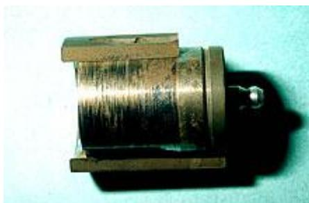
***Corrosion sous contrainte mécanique*** : Ce type de corrosion se définit comme un processus de développement de fissures, pouvant aller jusqu'à la rupture complète de la pièce sous l'action combinée d'une tension mécanique et d'un milieu corrosif.
