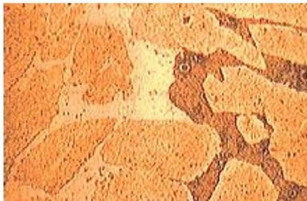
***Corrosion avec frottement*** : la corrosion-frottement concerne les dommages provoqués par la corrosion au niveau du contact de deux surfaces métalliques en mouvement relatif l'un par rapport à l'autre.
