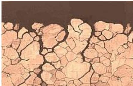
***Corrosion-fatigue*** : La corrosion-fatigue se distingue de la corrosion sous contrainte par le fait que les contraintes appliquées sont plus statiques, mais cycliques (efforts périodiques alternés).
