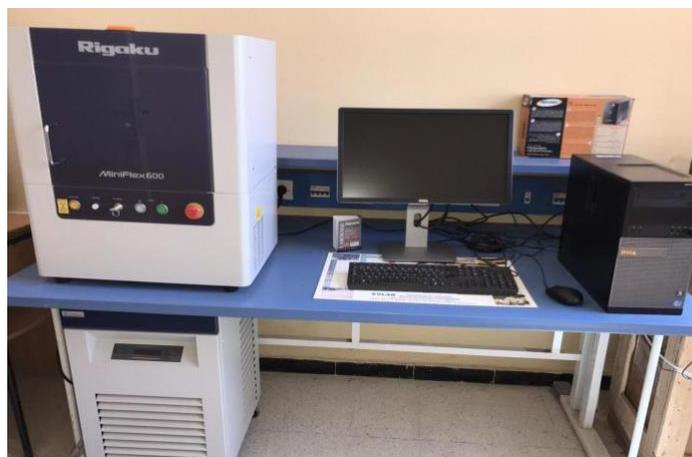
Figure II.5. Le diffractomètre « Rigaku MiniFlex 600 »
