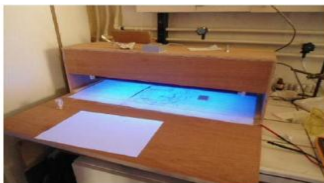
Figure.II.4 : Dispositif d'irradiation UV
