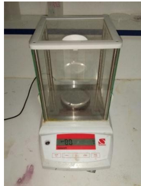
Figure.II.1 : La balance électrique utilisée pour la pesée des mélanges
