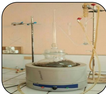
Figure 04 : Montage d'un hydrodistillateur type Clevenger
