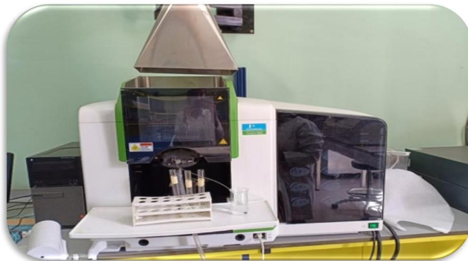
**Figure 14: Spectromètre d'absorption atomique à flamme (Toxicomed)**
