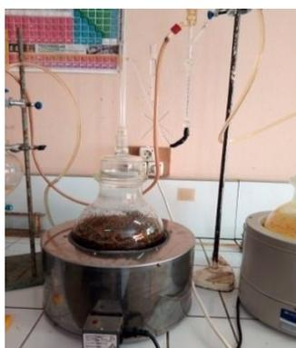
**Figure 06.** Montage d'hydrodistillation type clevenger (photo originale)
