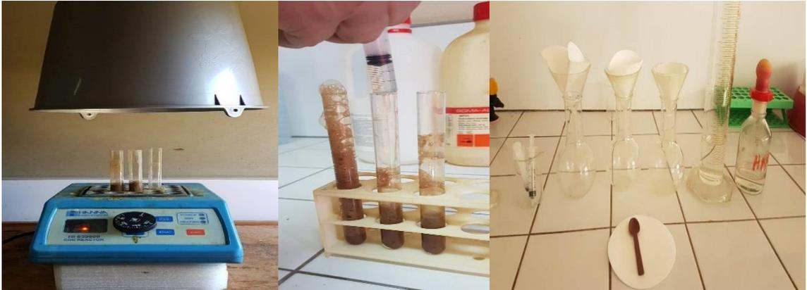
**Figure III-12** : Minéralisation et filtration des sédiments (photos originales)
