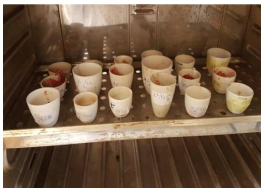
**Figure III-6** : Séchage à l'étuve des échantillons (photo originale)
