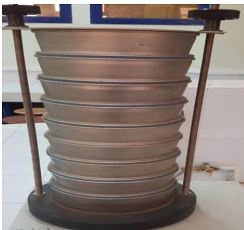
**Figure III-11** : Tamisage et échantillonnage des sédiments (photo originale)
