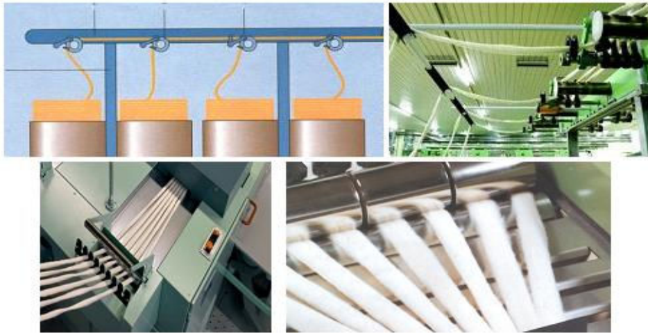
Figure III- 8 : Dispositifs d'alimentation du banc d'étirage.
