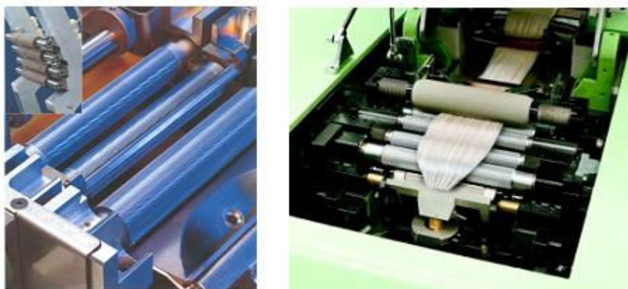
Figure III – 4 Vues du système de laminage
