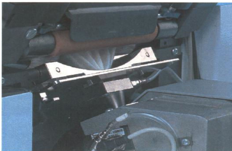
Figure III – 9 : Dispositif de formation du ruban sortant
