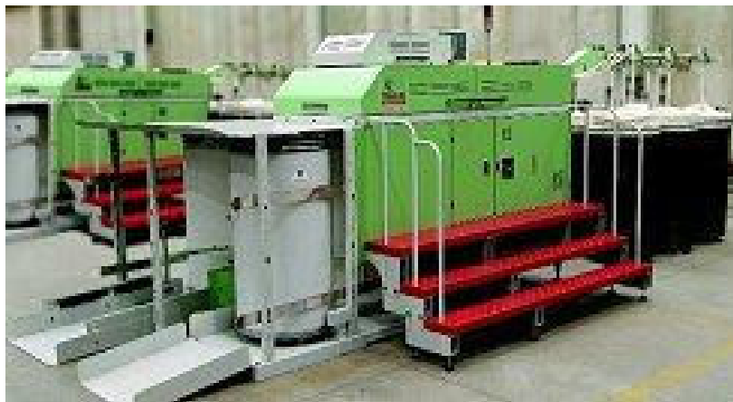
Figure III – 1 : Vue d'ensemble d'un banc d'étirage
