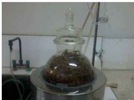
Fig. 21 : Montage d'hydrodistillation de type Clevenger (Source : Bechlaghem Karima)
