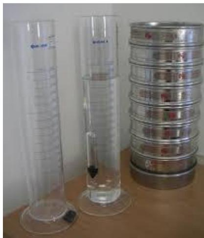
**Figure II.9** : Dispositif expérimental de la granulométrie par tamisage
