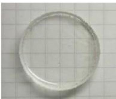
**Figure II.13:** Photographie d'un réseau de poly(PEA) après l'étape de polymérisation.
