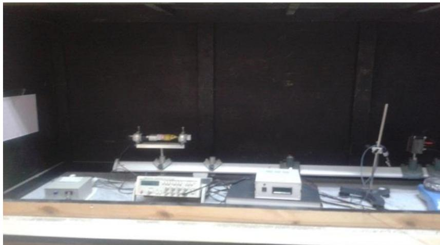
**Figure II.25:** Dispositif utilisé pour mesurer l'indice de réfraction des échantillons.
