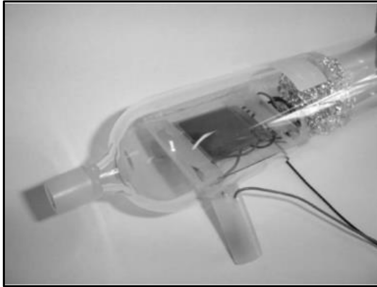
Figure III. 9 : Une technique d'encapsulation efficace mais laborieuse consiste à sceller dans une ampoule en verre sous vide [34].
