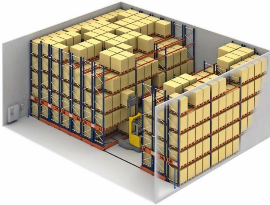
Figure 1.6.3: Schéma en 3D d'un AS/RS à racks glissants [3]
