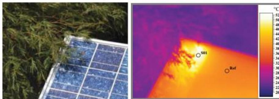
**Fig. I.24 :** Formation d'un *hot spot* dans une cellule photovoltaïque [1].
