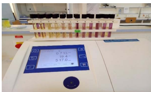
Figure 29 : Réduction du radical DPPH du violet au jaune.
