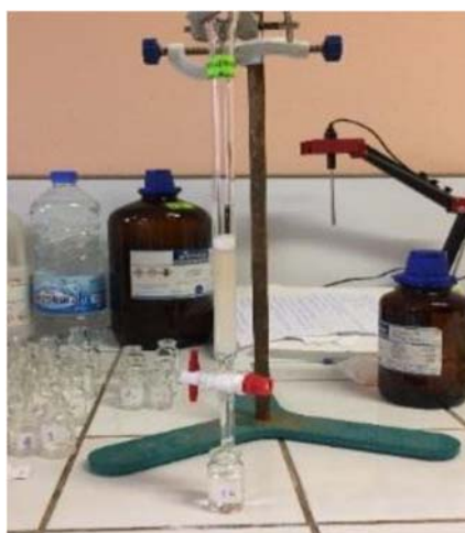
Figure 28 : Fractionnement des huiles essentielles
