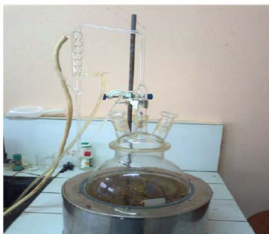
Figure 27 : Dispositif de l'extraction des huiles essentielles de type Clevenger
