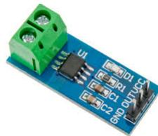
FIGURE II.16 – Capteur de courant ACS712
