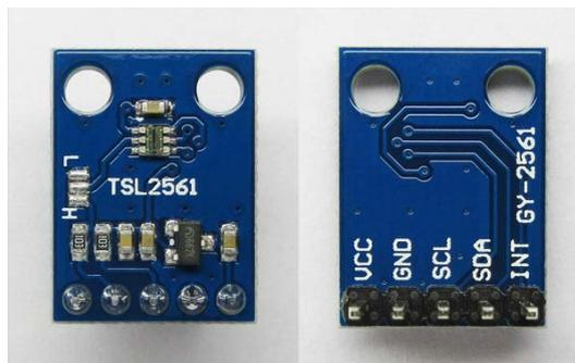
FIGURE III.4 – le capteur d'éclairage [8].
