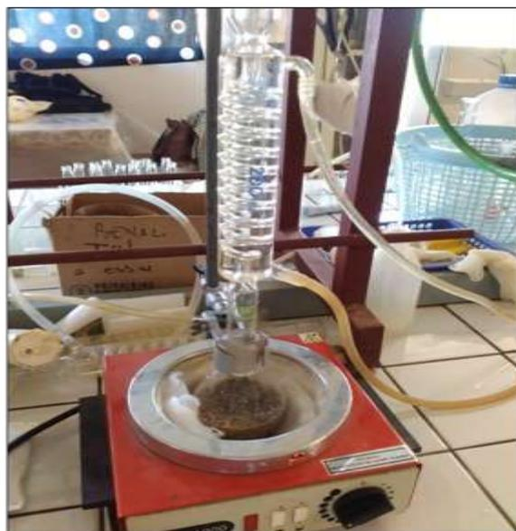
**Figure 23 :** Montage à reflux.
