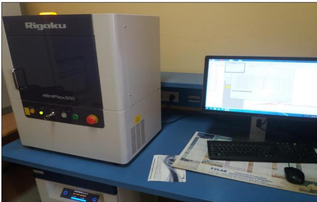
**Figure 92** : Diffraction des Rayons X (DRX).
