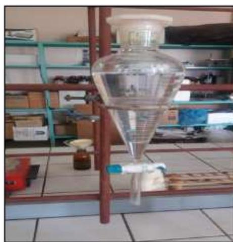
**Figure 36** : Extraction liquide-liquide.
