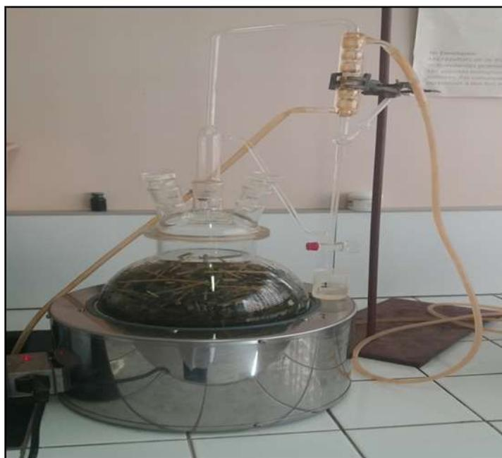
**Figure 34** : Dispositif d'hydrodistillation de type Clevenger.
