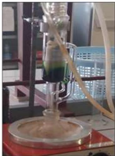
Figure 24 : Montage d'extraction au soxhlet.
