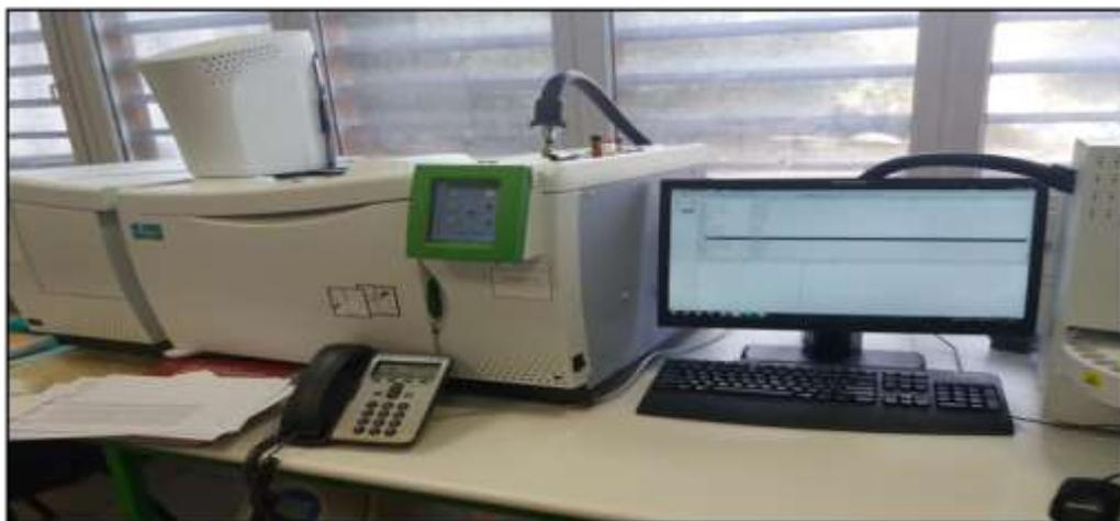
Figure 38 : Chromatographe en phase gazeuse couplé à un spectromètre de masse.
