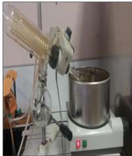
Figure 25 : Evaporateur rotatif.
