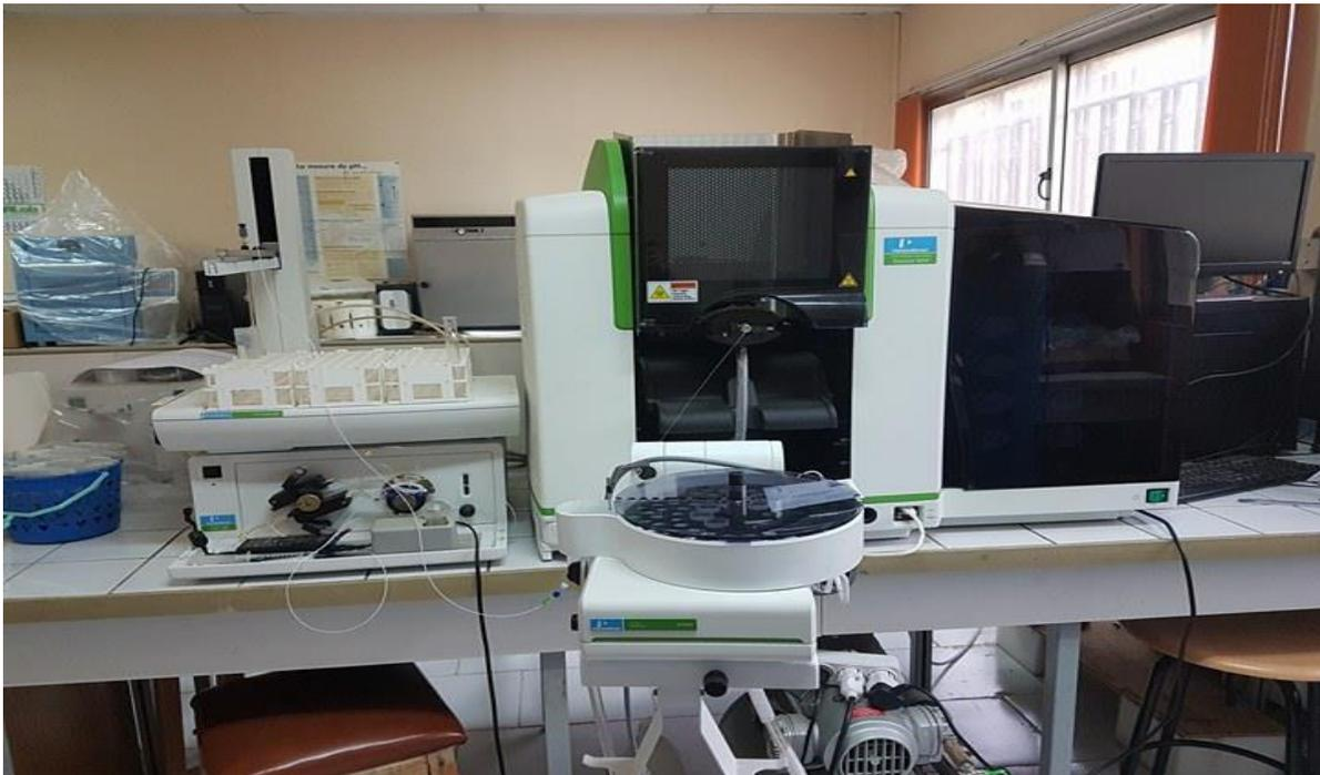
**Figure 9 :** Spectrophotomètre d'absorption atomique à flamme
