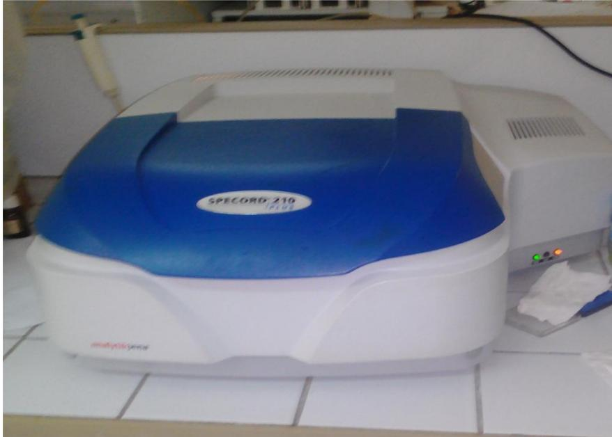
**Figure 10 :** Spectrophotomètre UV-Visible type (SPECORD 210/plus)
