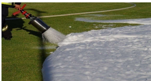
Figure I.0.18 :Mousse à bas foisonnement
