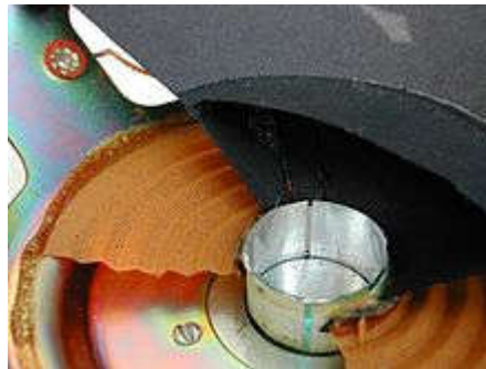
Figure IV.22: Coupe dans le moteur du haut-parleur : bobine et suspension arrière
