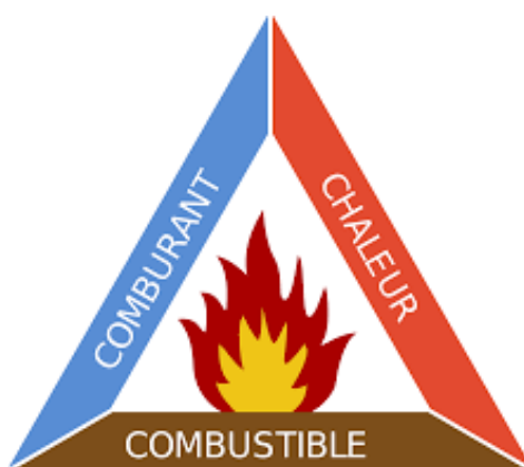
Figure I.0.1:le triangle du feu de combustion
