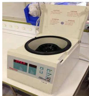
Figure 46: Centrifugeuse utilisée pour la formation de PRF.
