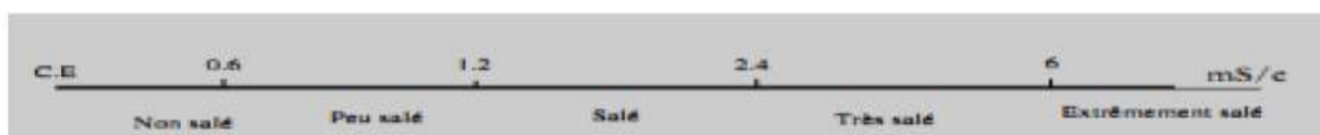
Figure 11: Echelle de salure en fonction de la conductivité de l'extrait aqueux au 1/5 Richards in (Aubert 1978).
