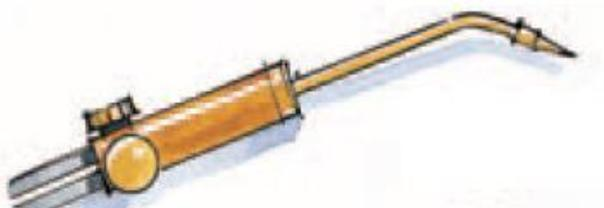
Fig .05 : Chalumeau soudeur et chauffeur à haute pression sans aspiration (Hée et Lefebvre, 2009)
