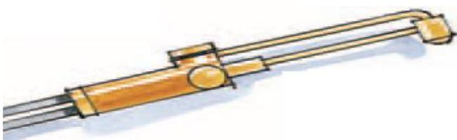
Fig .07 : Chalumeau coupeur à mélange dans la buse de coupe munis de 3 conduits (Hée et Lefebvre, 2009)
