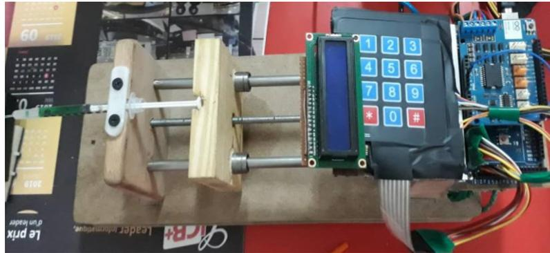
Figure 3- 41 pousse seringue réalisé par notre équipe[171]
