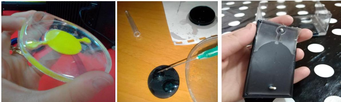
Figure 3- 36 Décollements du PDMS (micropompe plane, microvalves, membrane)
