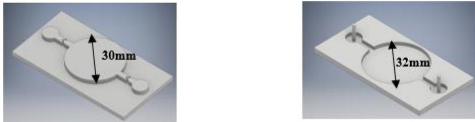
Figure 3- 33 Moule négatif de la chambre de pompage, membrane et microvalves sous Inventor
