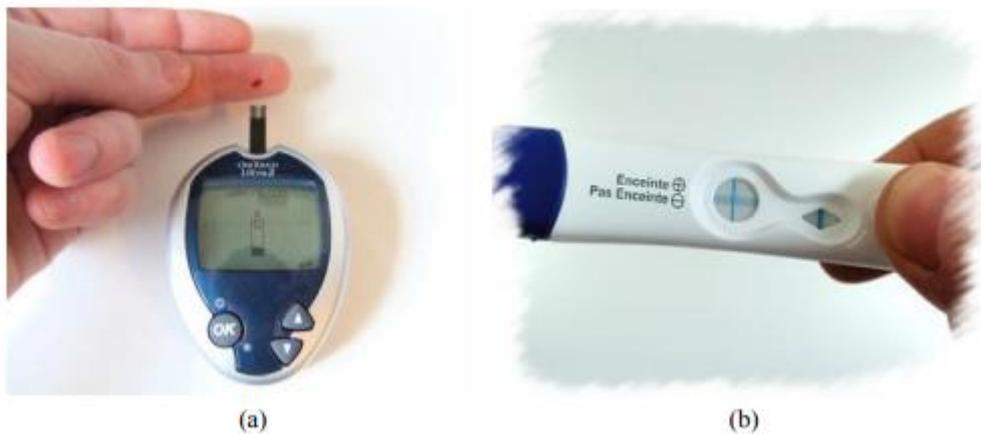
Figure 2- 2 Exemple de mini-laboratoires commercialisés, (a) mesure du taux de glycémie et (b) test de grossesse
