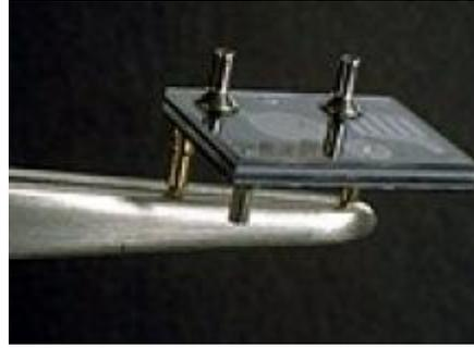
Figure 2- 6 Pompe en silicium permettant la délivrance contrôlée de médicaments Debiotech SA, (2004) [89]
