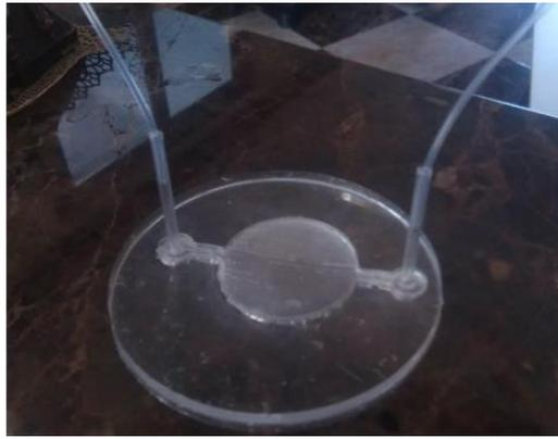
Figure 3- 38 Assemblage de la micropompe PDMS
