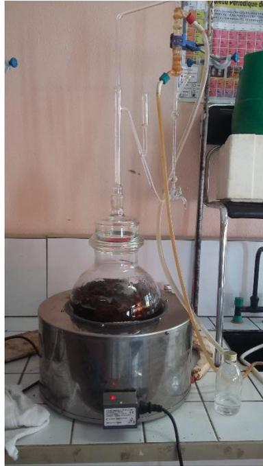
Figure 26 : Montage d'hydrodistillation type Clevenger
