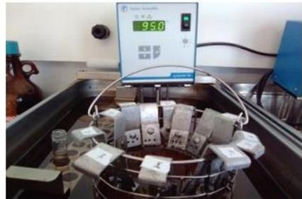
3. Traitement thermique des capillaires à différents barèmes temps/température
