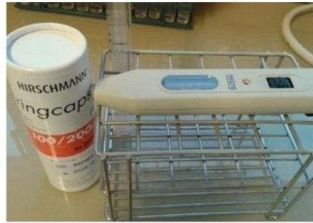
2. Introduction de 100  $\mu$ L de la suspension de spores diluée au centre des capillaires calibrés.
