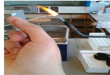
3. Soudure des extrémités des capillaires à la flamme.
