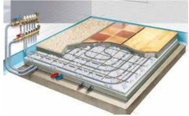
Figure4: 20 : Plancher chauffant/rafraichissant Source : Site internet
