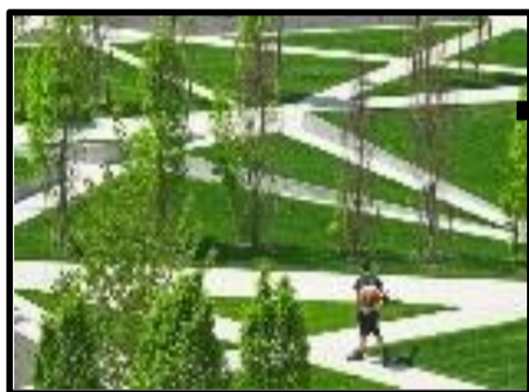
Figure 81: Les cheminements ne dépassent pas 7% source : https://www.french-art-concept.fr/fabrication-escalier-tremie.html
